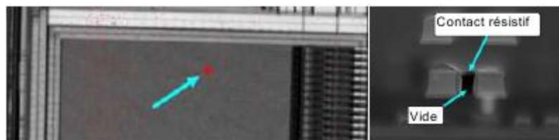
Figure I.3.4.2 : Cartographie SDL superposée à l'image optique du circuit. La zone sensible est pointée par la flèche (à gauche). Image MEB du défaut après coupe FIB (à droite) [HART 09].
