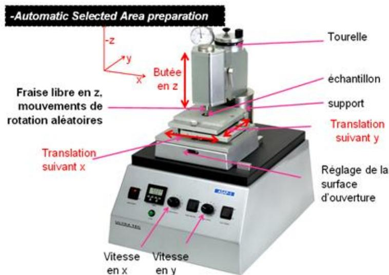
*Figure III.3.1.A.1 : Image de la machine d'ouverture des composants*
