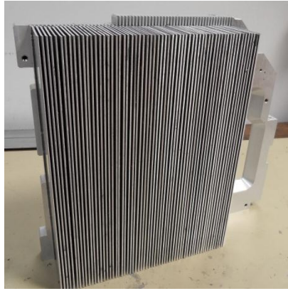
Figure 4-14 Photo du dissipateur des modules IGBT
