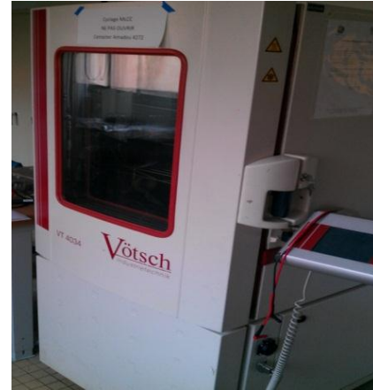
Figure 3-35 Conditions de cyclage thermique (profil imposé et enceinte climatique)
