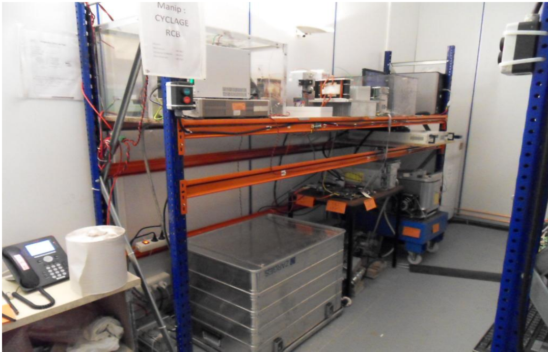
Figure 4-49 Banc de cyclage de la fonction Rotation
