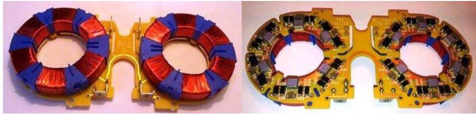
Figure 3-16 Photo d'un étage de transformation (à gauche : face arrière avec les deux transformateurs de l'étage ; à droite : face avant avec les circuits de redressement)
