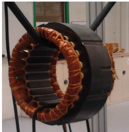
FIGURE 5.19 – Stator de la machine synchrone utilisé pour la validation expérimentale du modèle analytique
