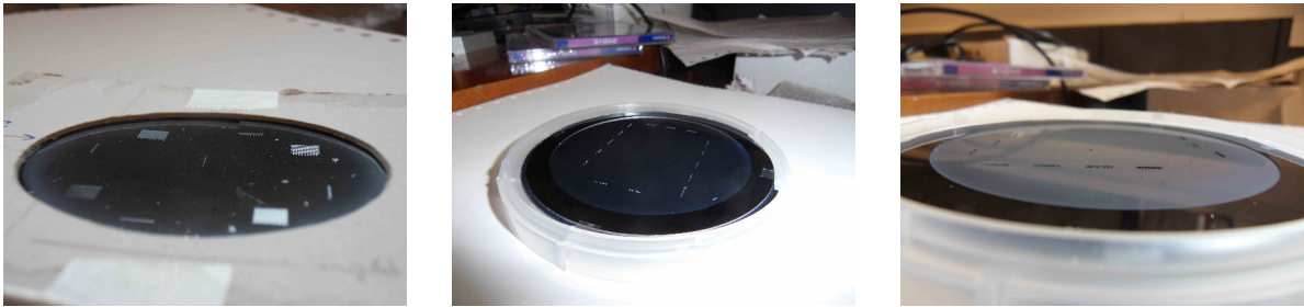
(a) Wafer 3inch (novembre 2013). (b) Wafer 4inch (mars 2014) de structures de lignes périodiques 1D (wafer n 0 W5). (c) Wafer 4inch (mars 2014) de structures de lignes aléatoires 1D (wafer n 0 W6).
