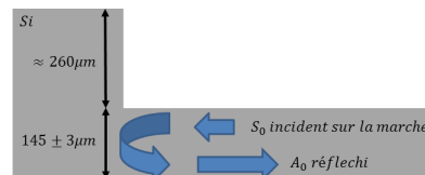
FIGURE 3.26 – Schéma de la conversion de mode observée en incidence normale pour S_0 .
