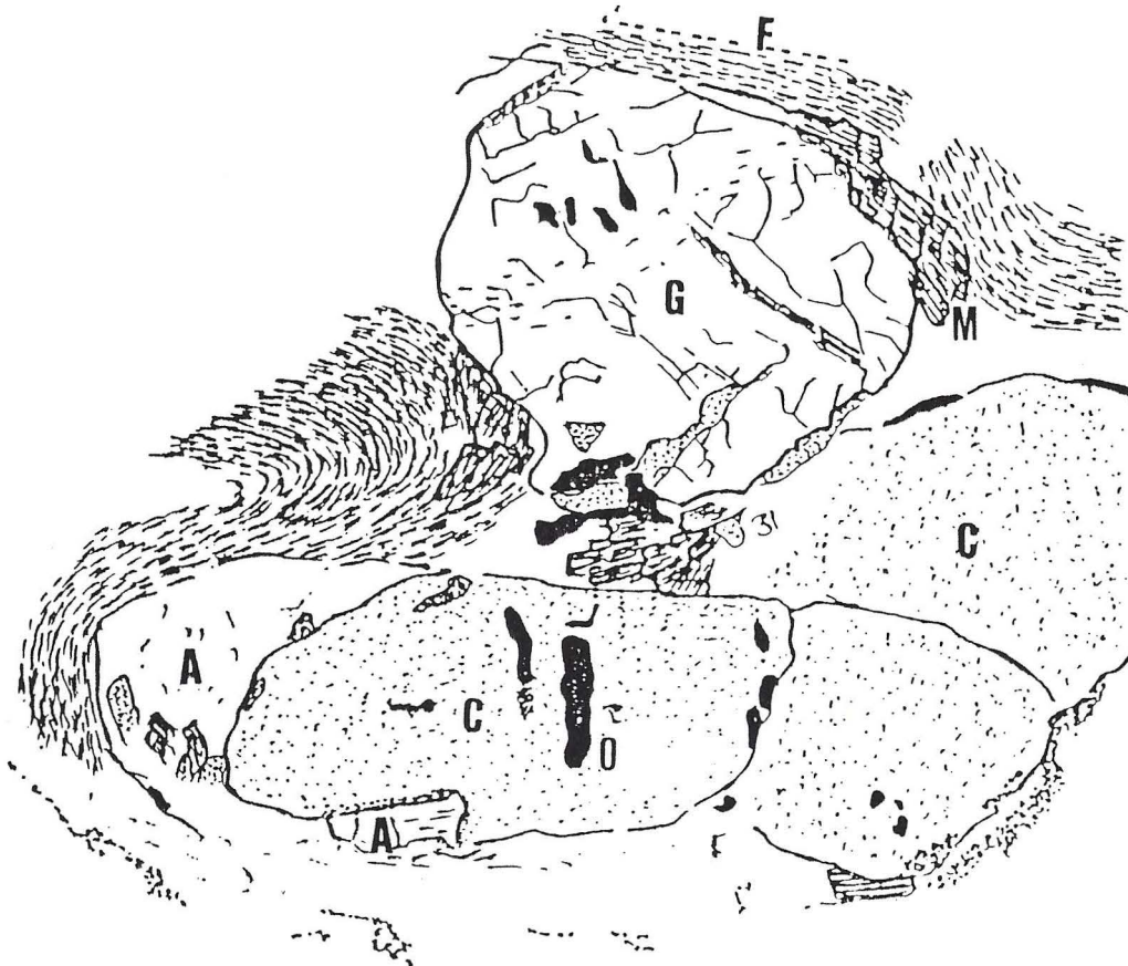
Fig. 59 a - Nodules de cordiérite moulées par la foliation de la matrice. (G = grenat, C = cordiérite pinitisée, A = andalousite, M = micas, O = opaques, F = foliation.)
