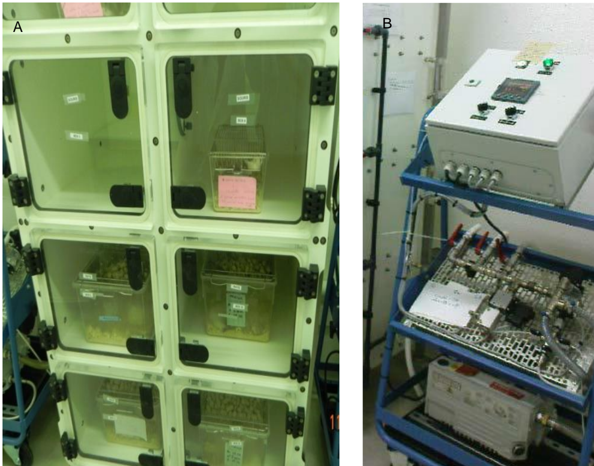
Figure 40: Dispositif utilisé pour la mise en place de l'HTP de groupe 3 : caisson hypobare.
