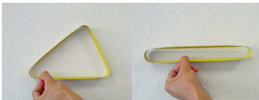
Figure 4.1: Deux positions d'équilibre pour un même jeu de conditions aux limites
