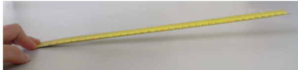
Figure 3.3: Essai de pincement : déformée finale d'un mètre ruban lorsque la section terminale gauche est totalement aplatie
