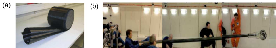
Figure 1.34: Ultralight CFRP deployable boom : (a) section du mât ; (b) essai de déploiement
