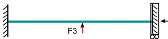
Figure 5.11: Essai de compression sur une poutre encastrée-encastrée
