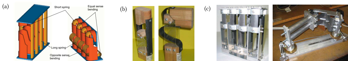
Figure 1.42: Charnières étudiées par Boesch et al : (a) schéma de principe ; (b) prototype 1 ; (c) prototype 2
