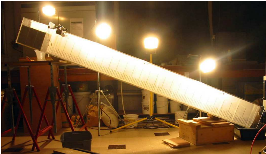
FIGURE 5 : Dispositif expérimental utilisé pour réaliser des écoulements granulaires. Une colonne granulaire est initialement contenue dans un réservoir en amont du canal et s'écoule lorsque nous ouvrons la porte. L'écoulement granulaire est filmé par une caméra rapide.
