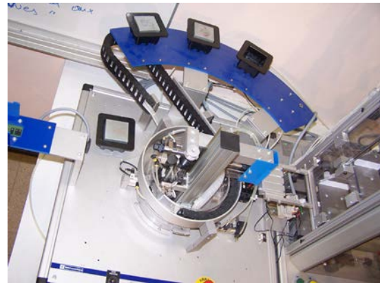
C : Bras rotatif avec les pièces métalliques
