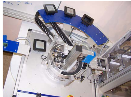
C : Bras rotatif avec les pièces métalliques
