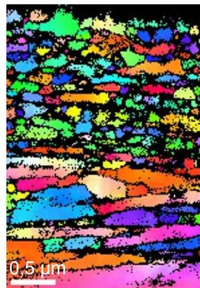
FIGURE 3.11 – Première carte EBSD d’orientation cristalline sur la couche blanche du 15-5PH obtenue sur une éprouvette de l’étude préliminaire (voir annexe A). Pas d’indexation 15 nm.
