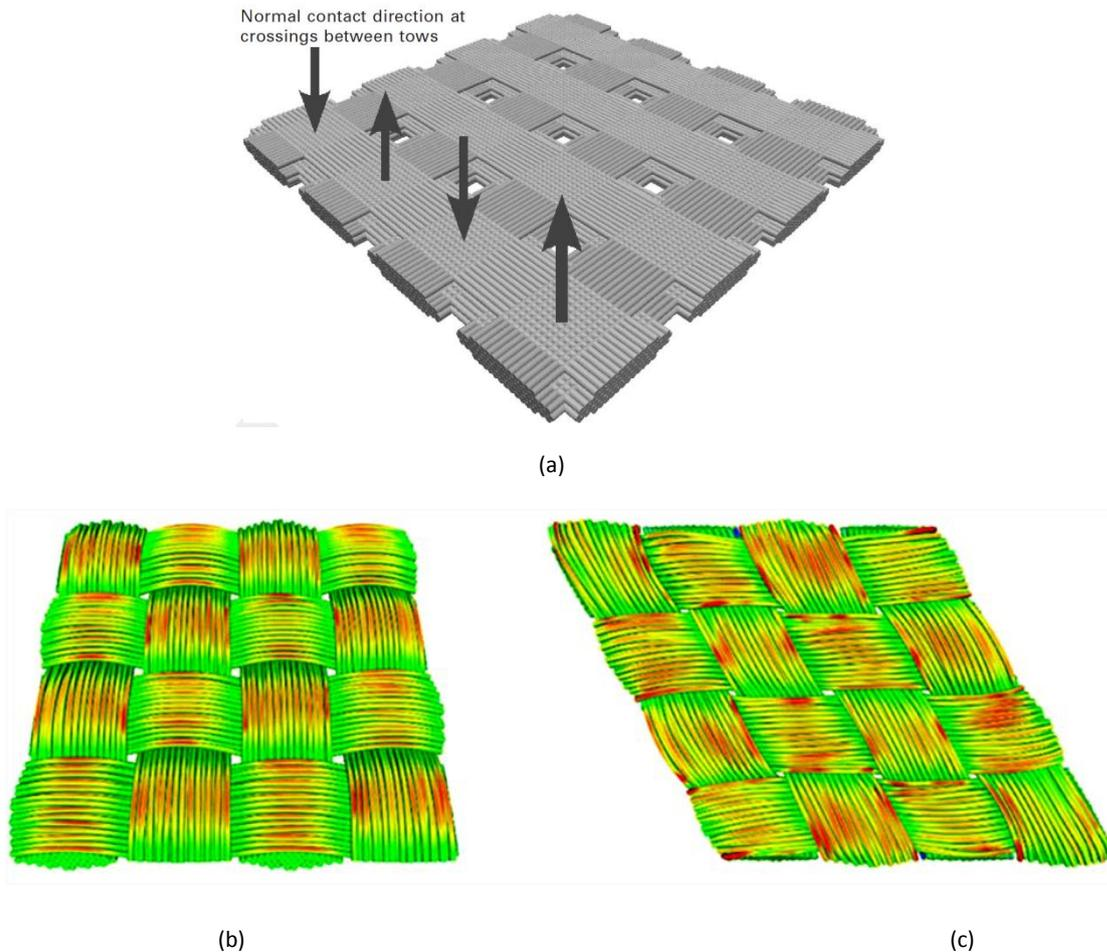
**Figure 3-16. Simulation à l'échelle microscopique du cisaillement d'un taffetas : (a) configuration initiale avec les directions de contact normal pour obtenir un tissu toile ; (b) état après tissage ; (c) état après cisaillement.**
