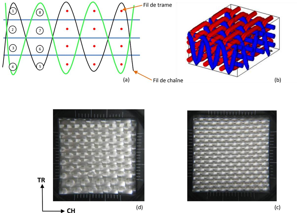
**Figure 5-20. (a) Schéma de l'armure du 3D orthogonal liage toile (coupe chaîne) ; (b) vue 3D du tissu interlock orthogonal liage toile (*WiseTex*) ; interlock orthogonal liage toile produit à base de fils en verre E de titrage : (c) 300 Tex et (d) 900 Tex.**
