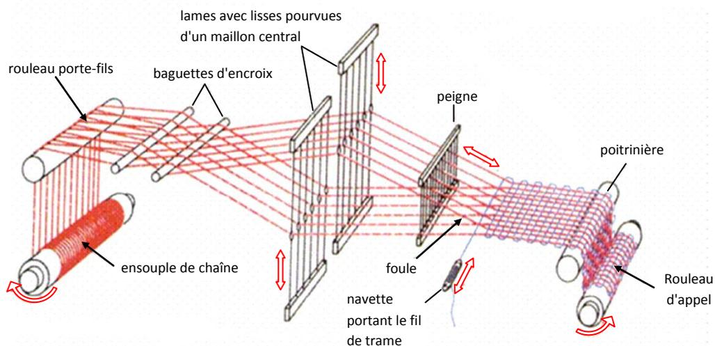
Figure 2-1. Schéma illustrant le principe de fonctionnement d'un métier à tisser [49].
