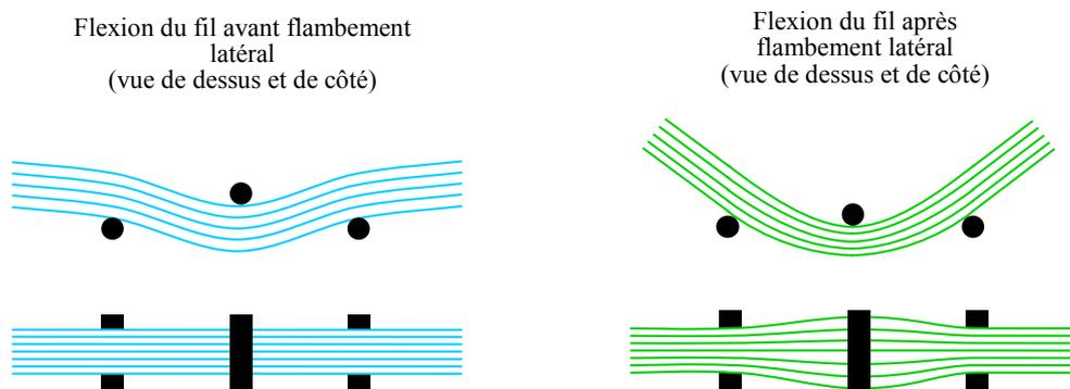
Figure 3-15. Phénomène de flambage intervenant dans la flexion d'un fil de renfort tissé [68].
