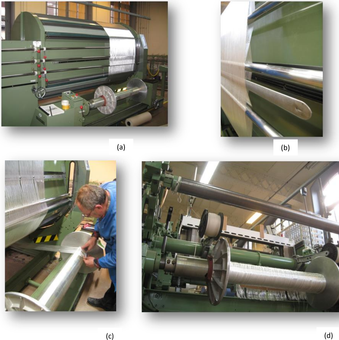
Figure 2-8. (a) Ourdissage d'échantillonnage du fil de verre E ; (b) croisure des fils de chaîne ; (c) dressage des fils de verre du tambour à l'ensouple ; (d) ensouple de fils de chaîne montée sur la machine à tisser.
