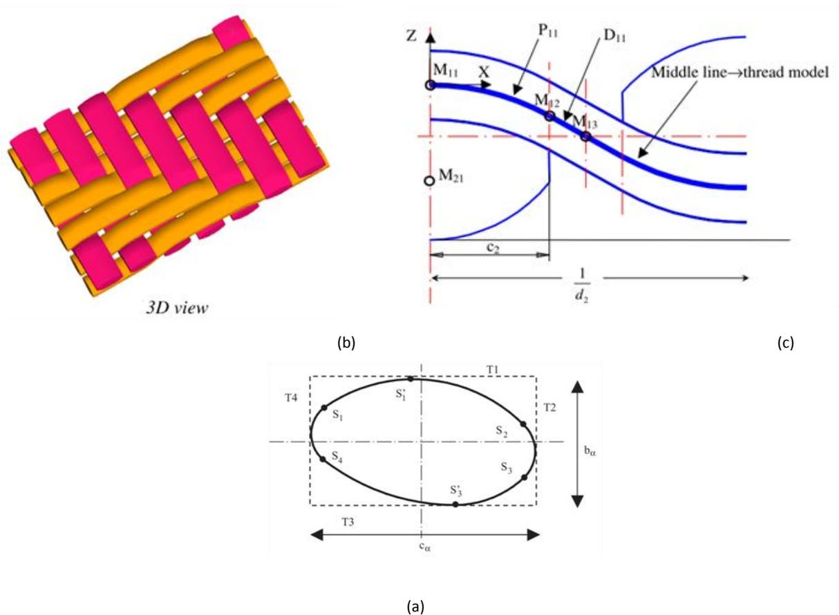
**Figure 4-5. (a) Rectangle qui circonscrit les sections des mèches ; (b) Modèle géométrique d'un sergé 4x3 ; (c) Modèle en treillis de la moitié d'un fil pour une cellule élémentaire de tissu toile dans la direction chaîne [16].**
