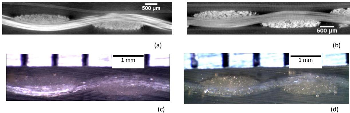
**Figure 5-31. Vues en coupe du tissu toile avec des fils de titrage 900 Tex en verre E, obtenues par tomographie X au laboratoire du LaMCoS : (a) coupe chaîne ; (b) coupe trame ; obtenues par résinage des tissus : (c) coupe chaîne ; (d) coupe trame.**
