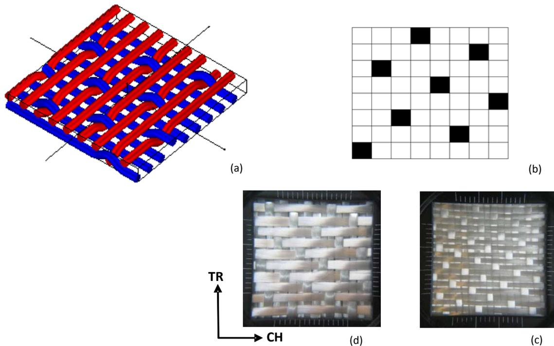
**Figure 5-16.** (a) Représentation de l'armure satin 8 effet trame décochement de 5 avec le logiciel Wisetex ; (b) armure satin 8 ; satin 8 produit à base de fils en verre E de titrage : (c) 300 Tex et (d) 900 Tex.
