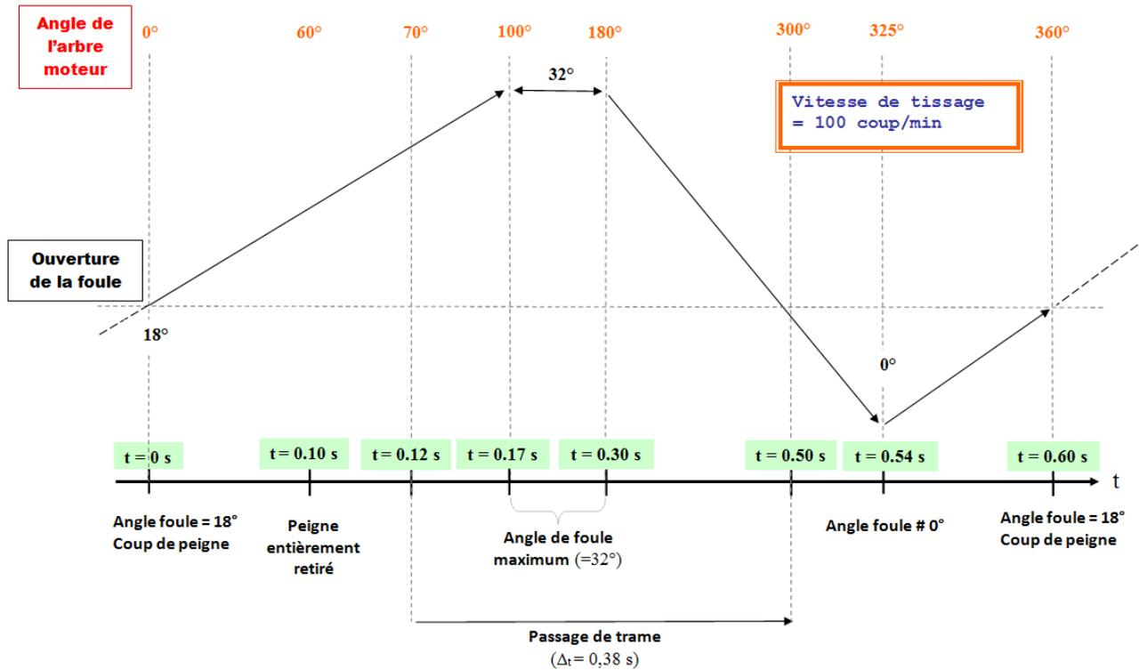
Figure 5-11. Un cycle de tissage sur la machine à tisser Dornier.
