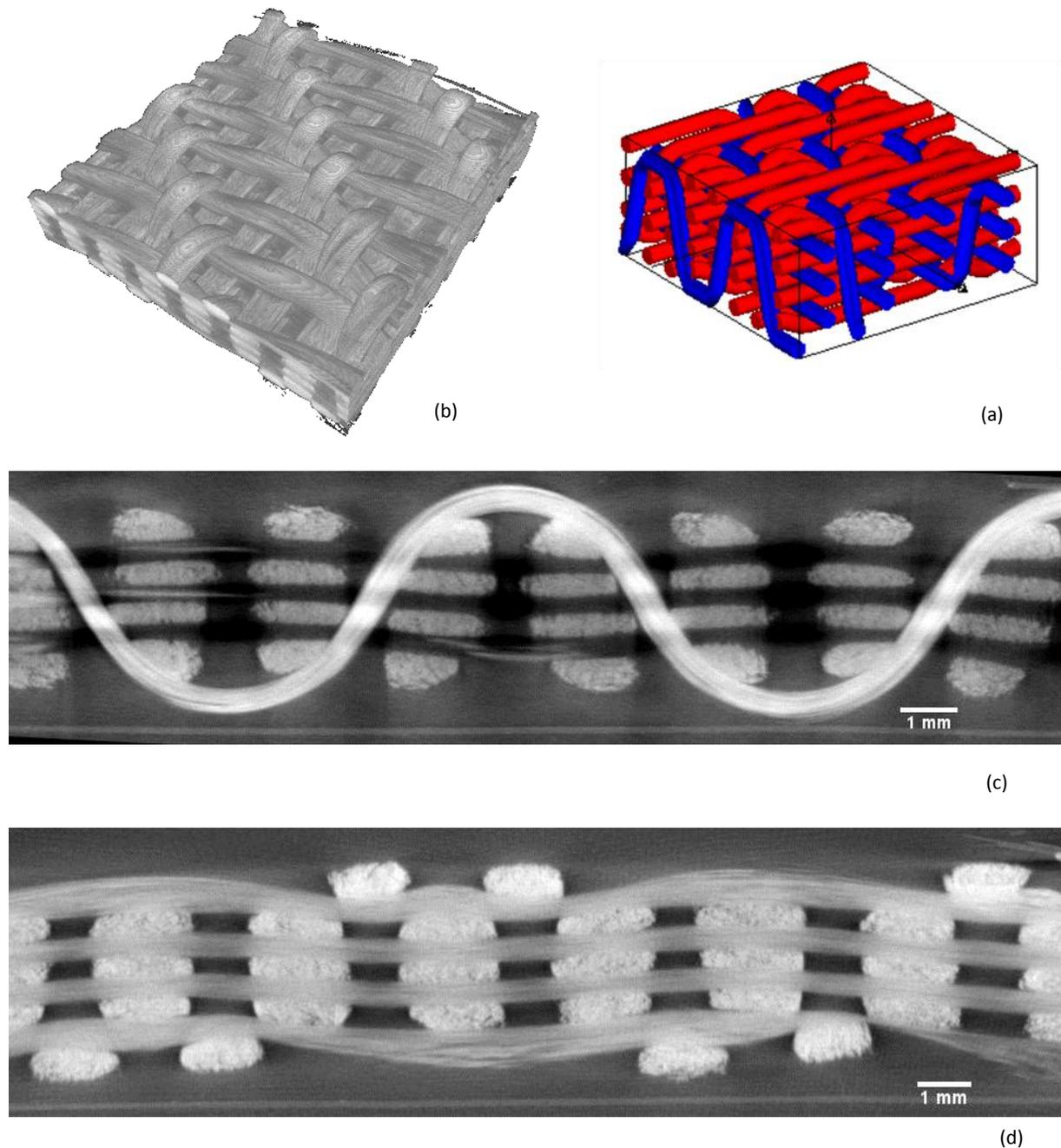
**Figure 5-35. Tissu interlock liage croisé 2-2 produit à l'ENSAIT composé de fils en verre E de titrage 900 Tex : (a) schéma WiseTex du tissu ; images du tissu réel obtenues par tomographie X au laboratoire du LaMCoS : (b) vue ISO, (c) vue en coupe dans le sens chaîne, (d) vue en coupe dans le sens trame.**
