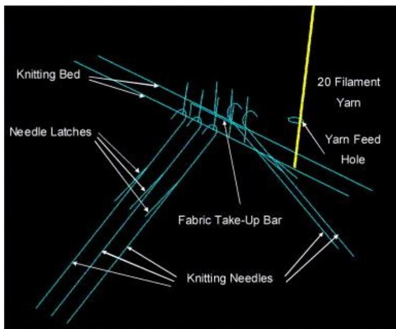
Figure 4-8. Etat initial de la simulation du tricotage [109].
