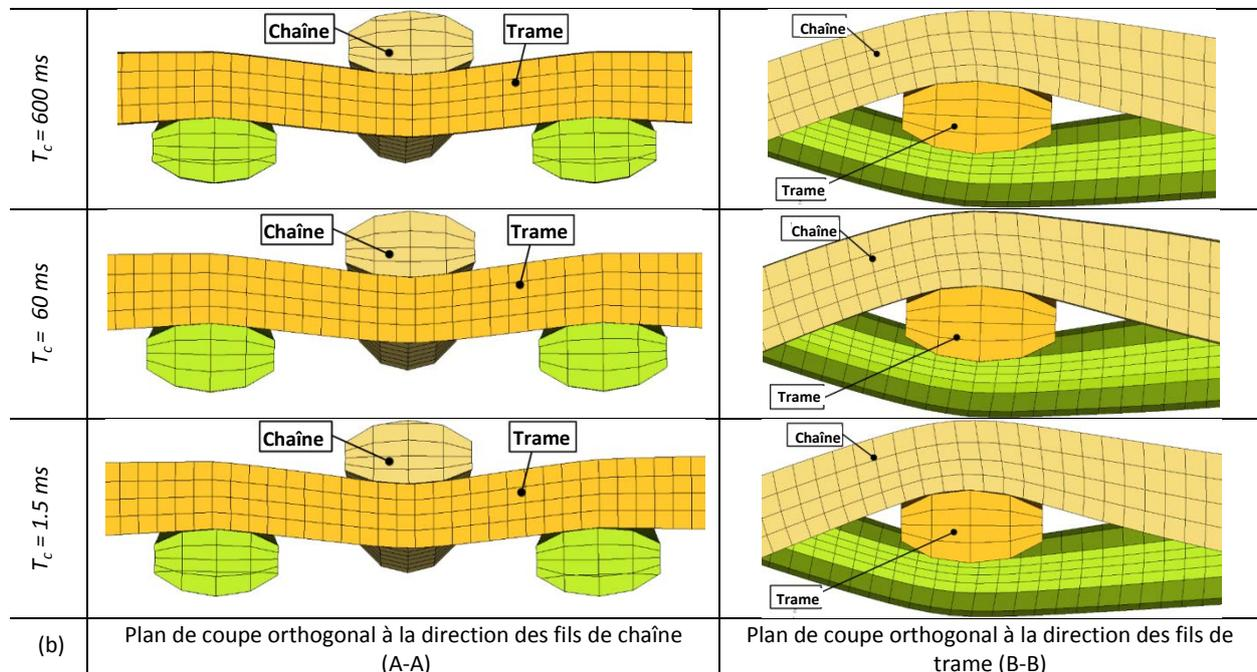
Figure 6-8. Effet de la durée du cycle de tissage : (a) entrelacement élémentaire utilisé pour les tests ; (b) contexture inchangé pour différentes vitesses de tissage.
