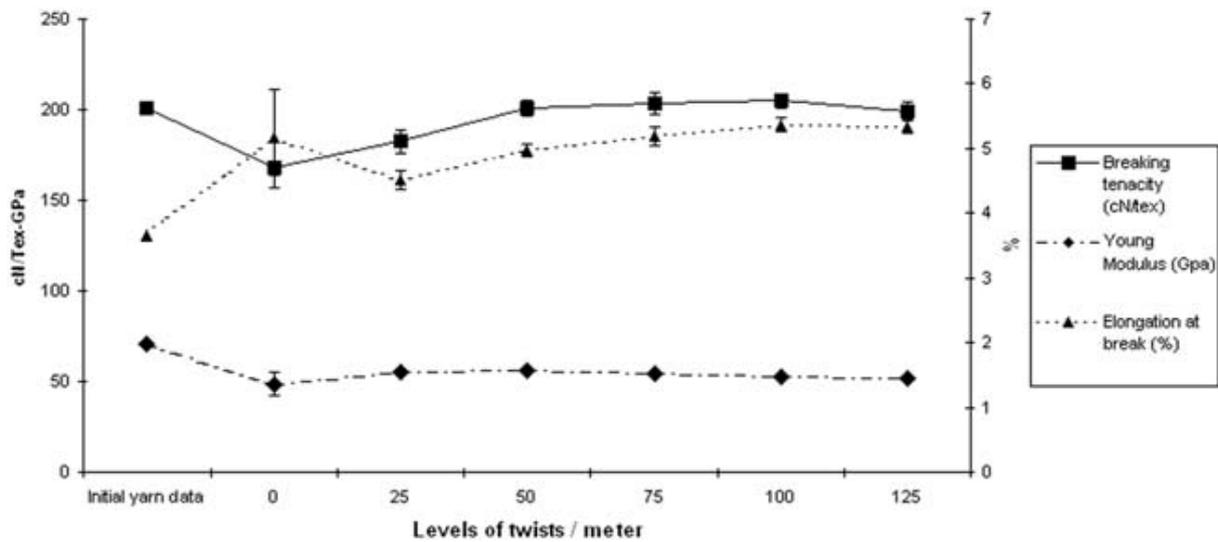
Figure 2-6. Caractéristiques mécaniques d'un fil de para-aramide.
