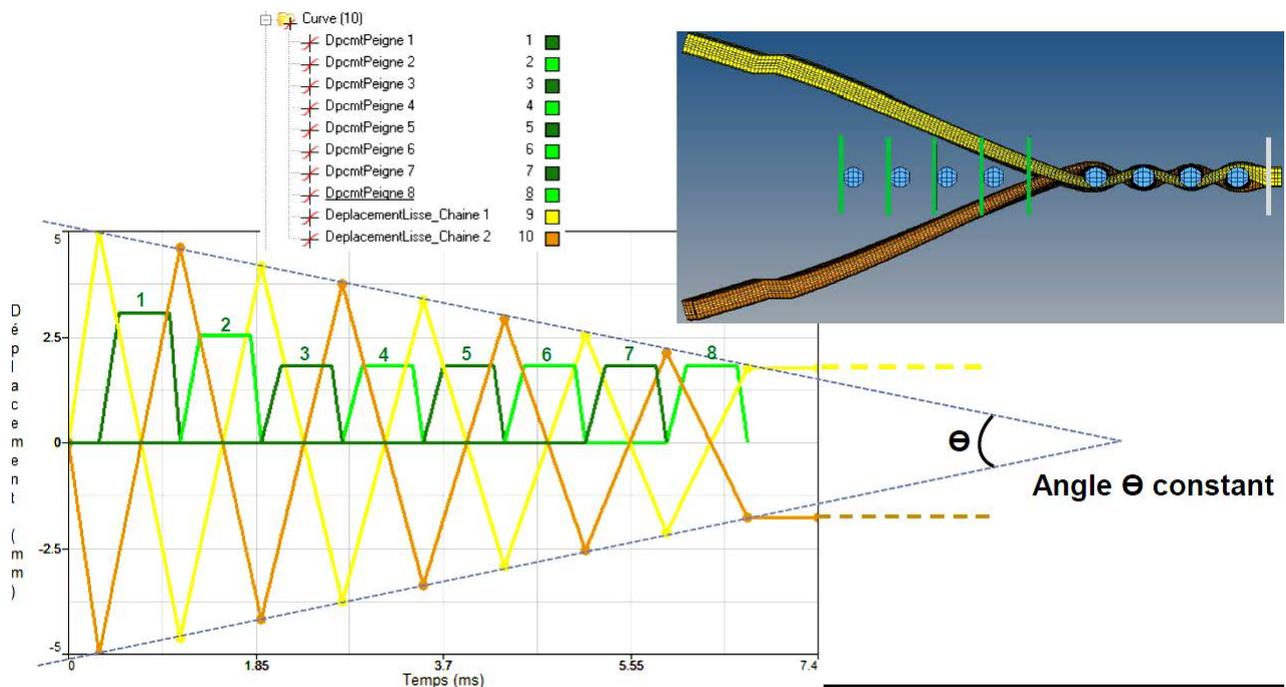
Figure 6-18. Descriptif des fonctions (déplacements imposés) dans l'outil d'automatisation de la simulation du CEDREM.
