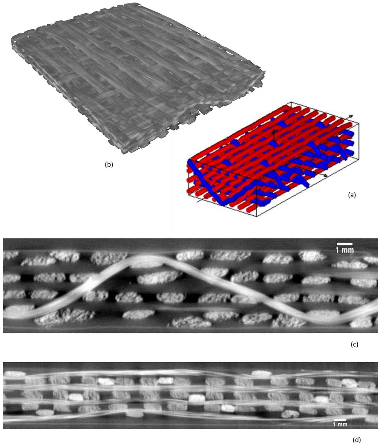
**Figure 5-36.** Tissu interlock liage satin 8 produit à l'ENSAIT composé de fils en verre E de titrage 900 Tex : (a) schéma WiseTex du tissu ; images du tissu réel obtenues par tomographie X au laboratoire du LaMCoS : (b) vue ISO, (c) vue en coupe dans le sens chaîne, (d) vue en coupe dans le sens trame.
