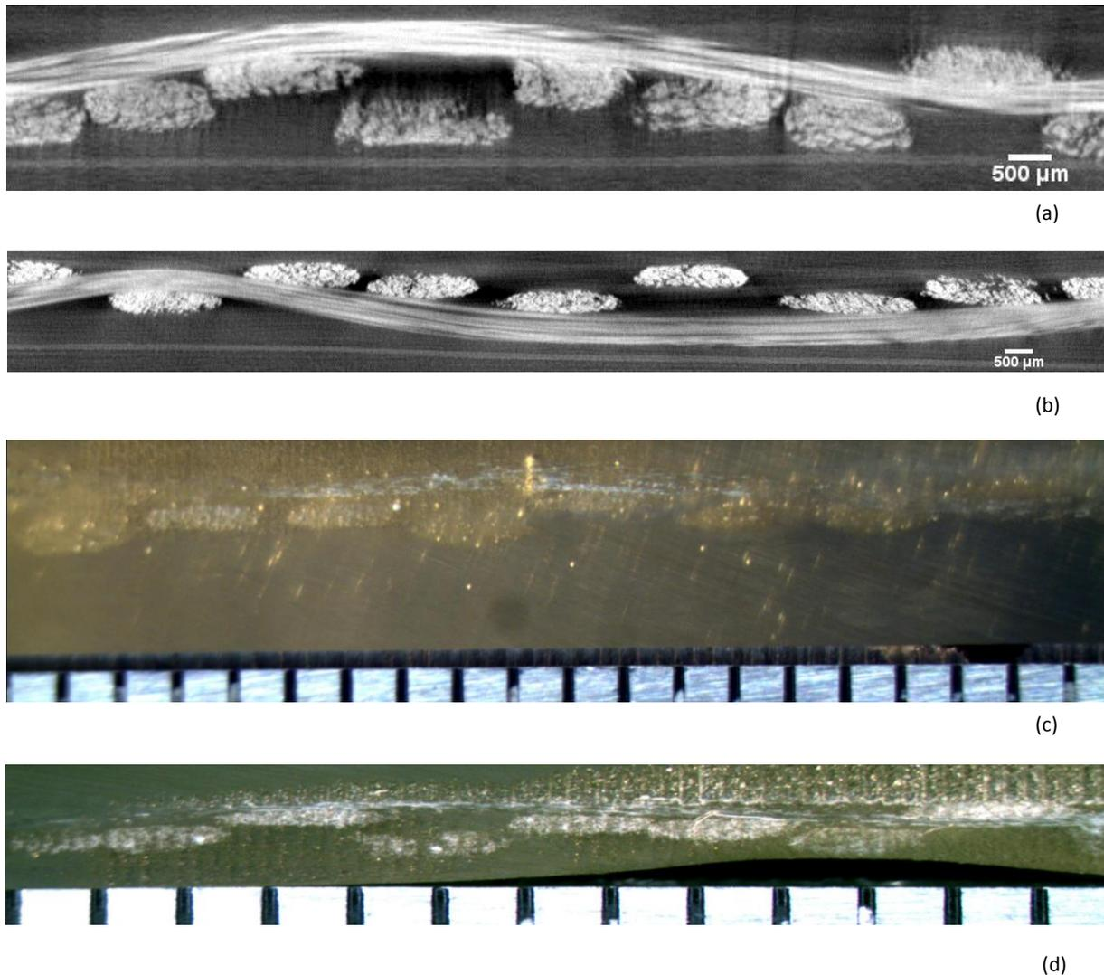
**Figure 5-33. Vues en coupe du tissu satin 8 avec des fils de titrage 900 Tex en verre E, obtenues par tomographie X au laboratoire du LaMCoS : (a) coupe chaîne ; (b) coupe trame ; obtenues par résinage des tissus : (c) coupe chaîne ; (d) coupe trame.**
