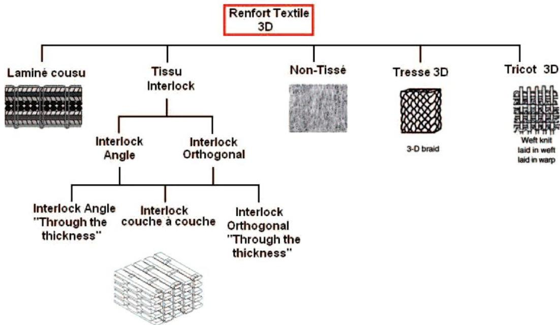
Figure 1-7. Classification des différentes structures textiles 3D [27].
