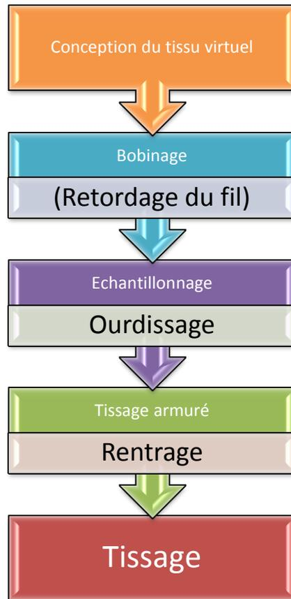
Figure 2-4. Etapes de réalisation du tissu à l'Ensait dans le cadre du projet NUMTISS.
