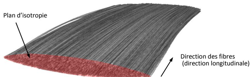
**Figure 3-17. Isotropie transverse du multifilament d'un renfort tissé.
