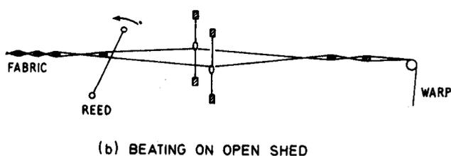
Figure 2-12. Tassement de la duite en foule ouverte.
