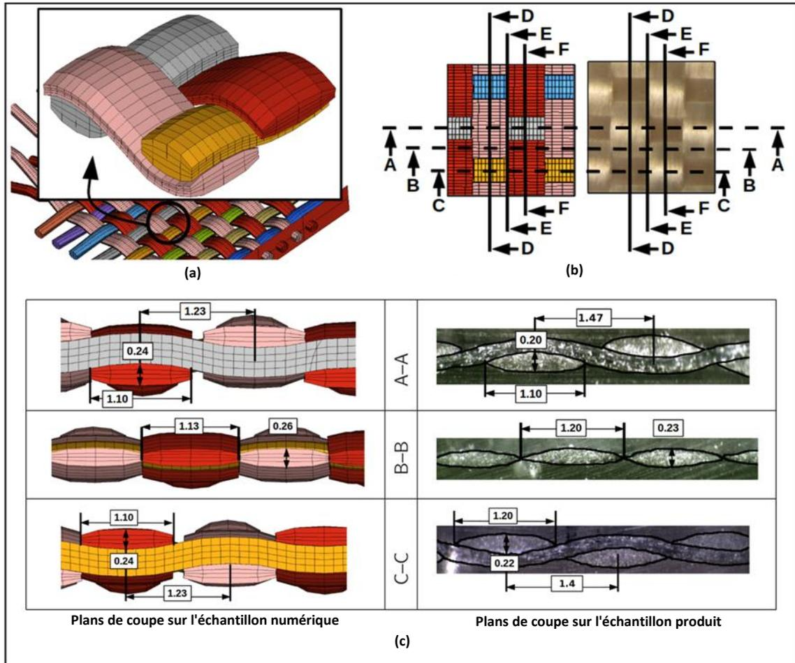
Figure 6-12. Comparaison entre les échantillons de tissu toile (1/2) : (a) VER du tissu toile, (b) plans de coupe du VER, (c) plans de coupe orthogonaux à la direction chaîne (longueur en mm).
