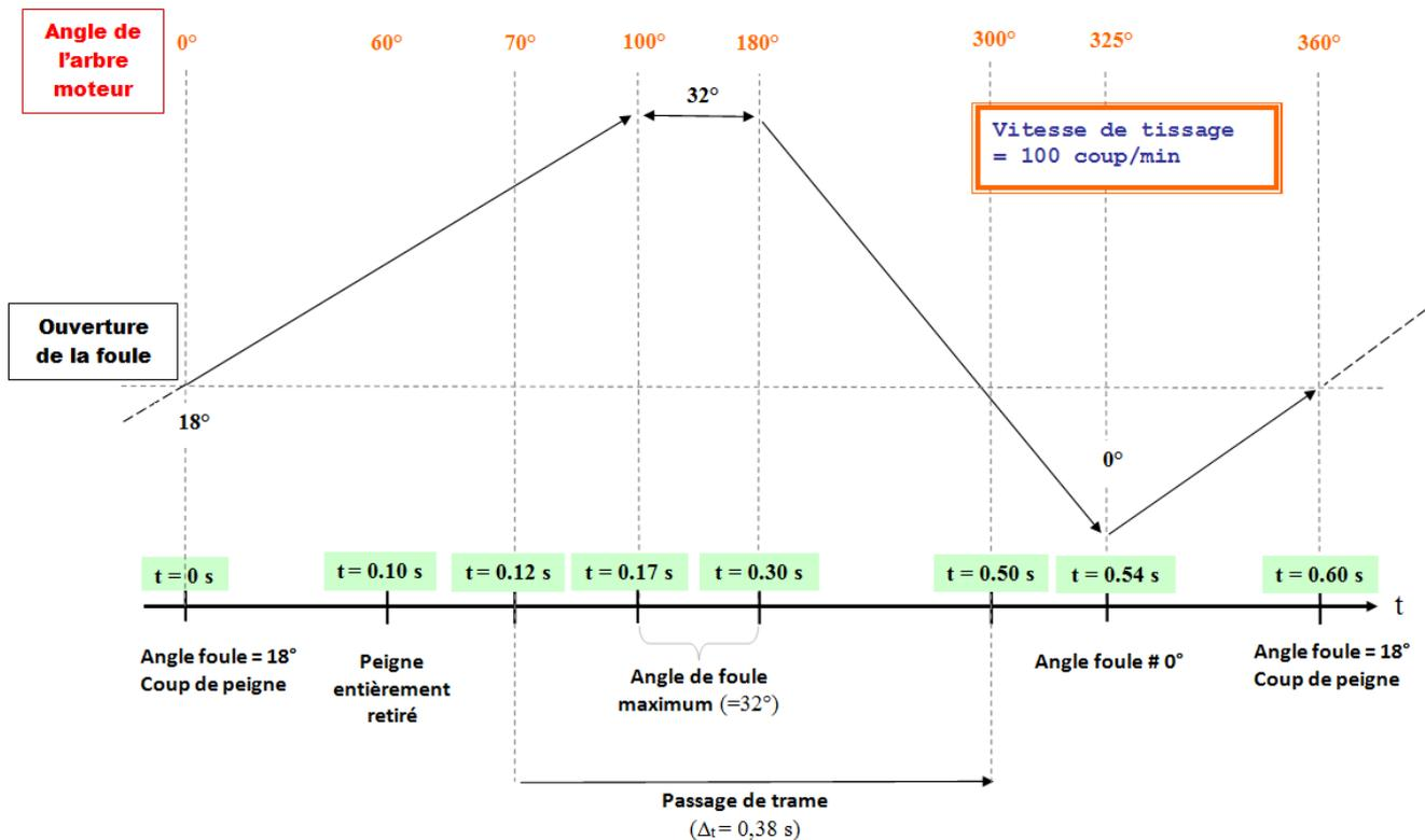
Figure 6-7. Un cycle de tissage sur la machine à tisser Dornier®.
