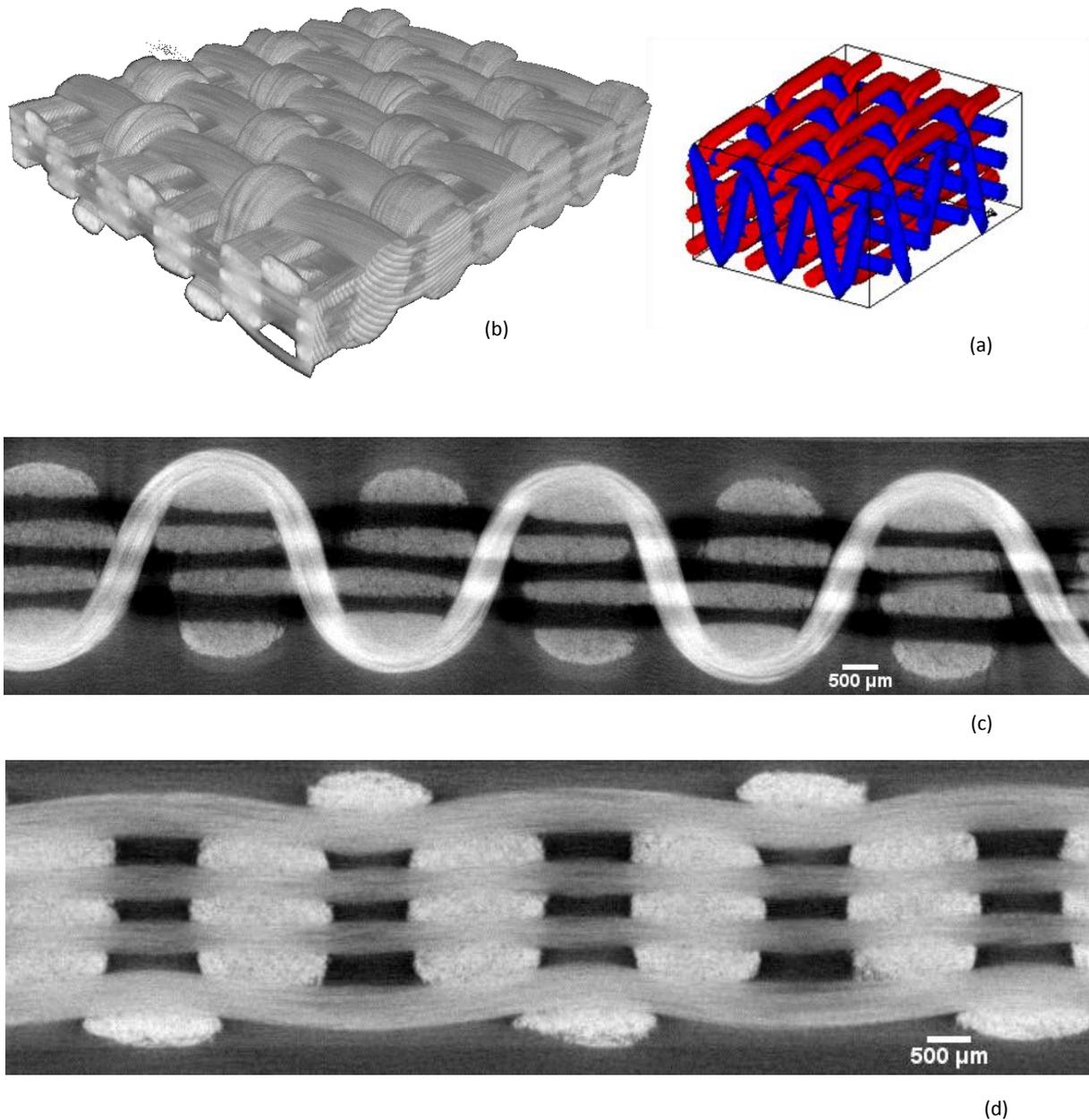
**Figure 5-34. Tissu interlock liage toile produit à l'ENSAIT composé de fils en verre E de titrage 900 Tex :**
