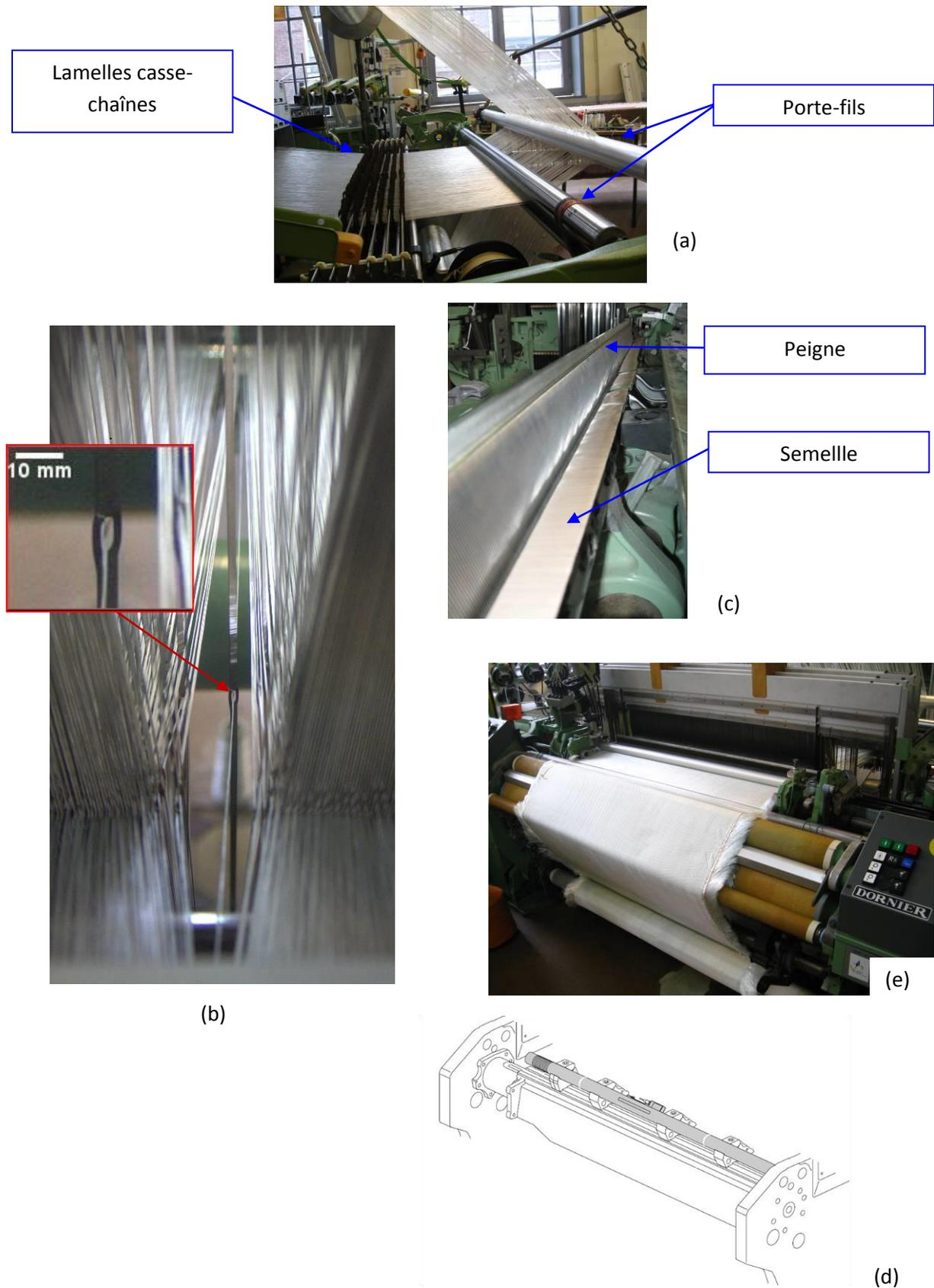
**Figure 5-3. Éléments de la machine à tisser Dornier en contact avec les fils de chaîne : (a) porte-fils et lamelles casse-chaînes ; (b) lisses ; (c) peigne et semelle ; (d) palpeur de tension de chaîne [173] ; (e) rouleaux d'appel.**
