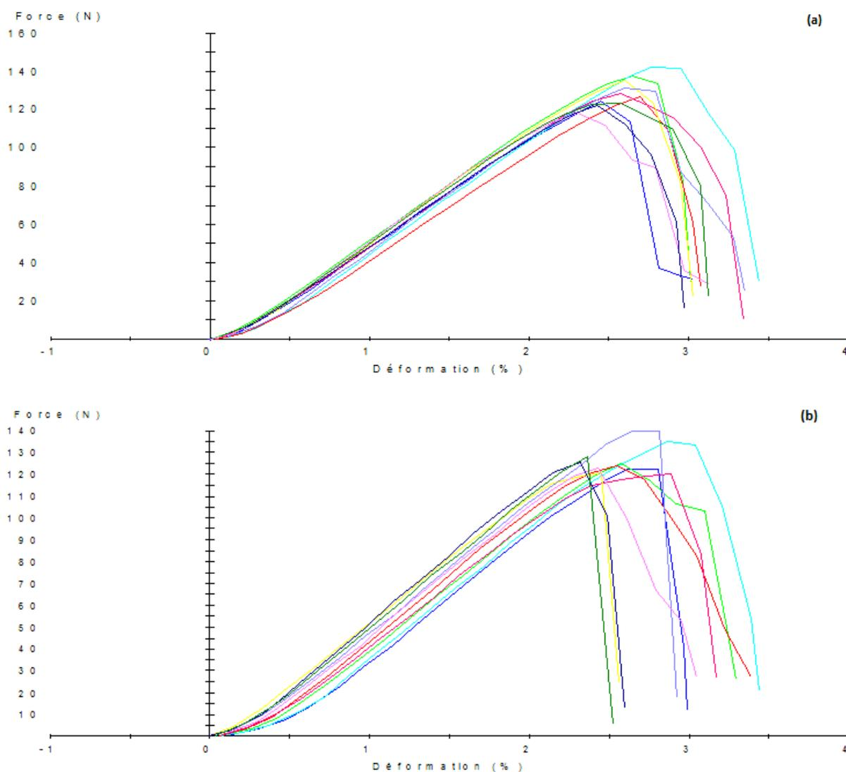
**Figure 5-13. Test d'allongement à la rupture pour deux groupes de rovings de verre de 300 Tex (retordus et non retordus), avec la force en fonction de l'allongement relatif : (a) rovings non retordus. (b) rovings retordus à 25 tr/m.**
