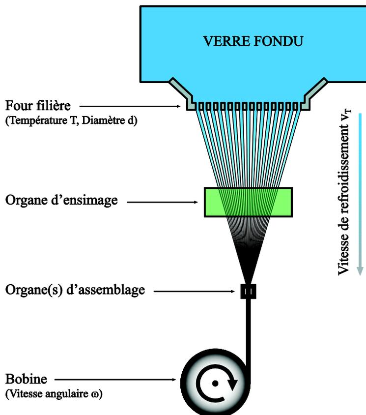
Figure 1-2. Procédé de filage et d'assemblage des multi-filaments de verre [25].
