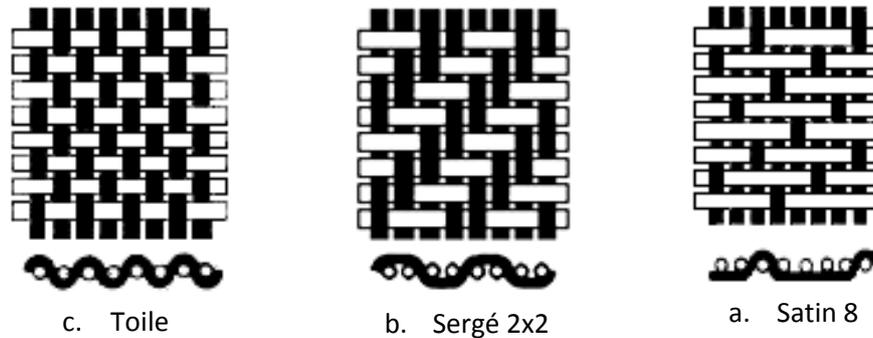
Figure 1-5. Les trois armures fondamentales du tissage [171].
