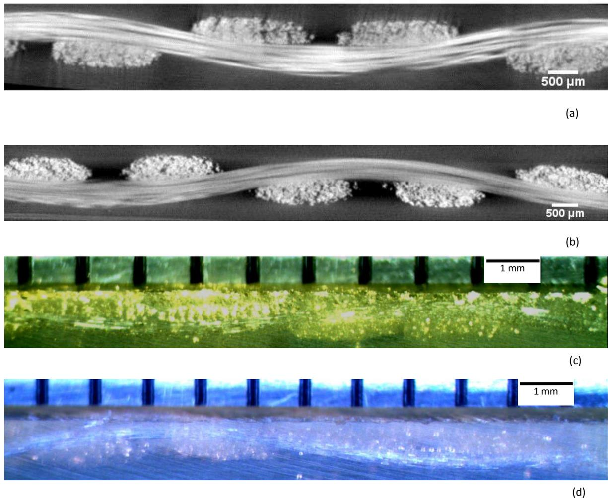
**Figure 5-32. Vues en coupe du tissu croisé 2-2 avec des fils de titrage 900 Tex en verre E, obtenues par tomographie X au laboratoire du LAMCOS : (a) coupe chaîne ; (b) coupe trame ; obtenues par résinage des tissus : (c) coupe chaîne ; (d) coupe trame.**
