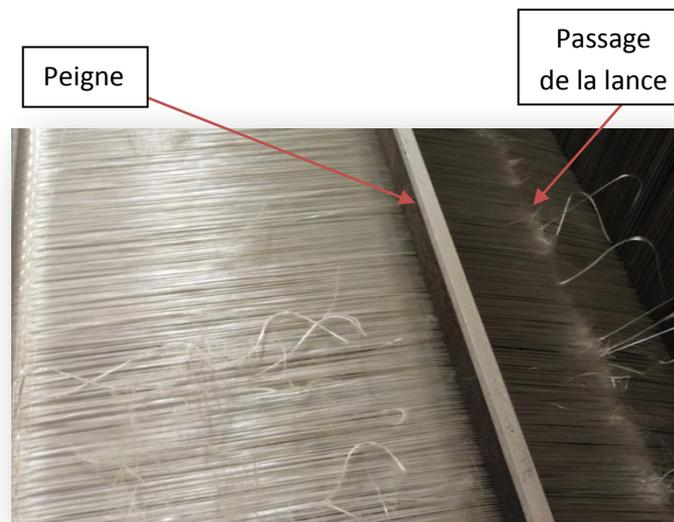
Figure 5-18. Casses des filaments lors de la production des tissus interlocks en fils de verre E de titrage 300 Tex.
