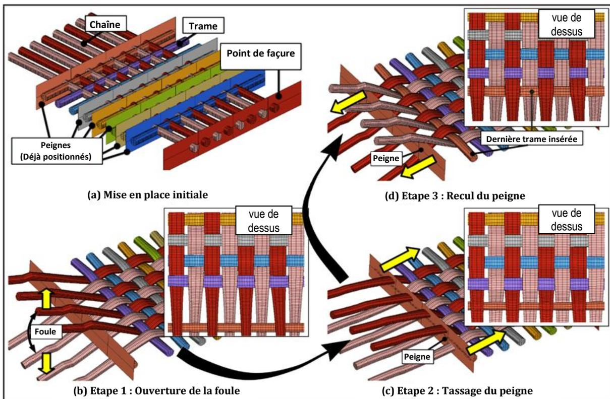
Figure 6-11. Étapes clés de la production simulées.
