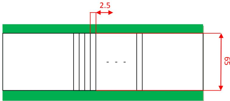
Figure 5-10. Géométrie du peigne avec 4 broches/cm (unité mm).
