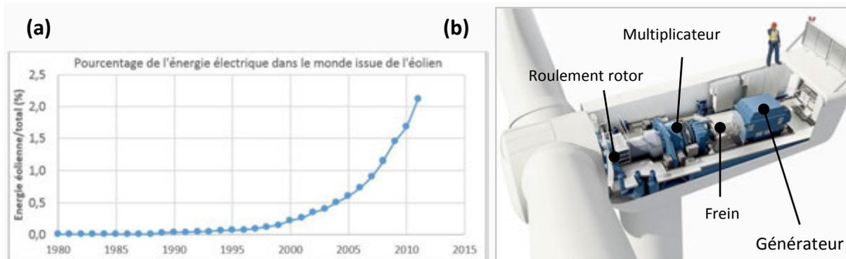
**Figure 1 :** (a) Pourcentage de l'énergie électrique dans le monde issue de l'éolien (données accessibles [1]); (b) Structure typique de la nacelle d'une éolienne multi-MW (ZF transmission, [www.zf.com](http://www.zf.com)).
