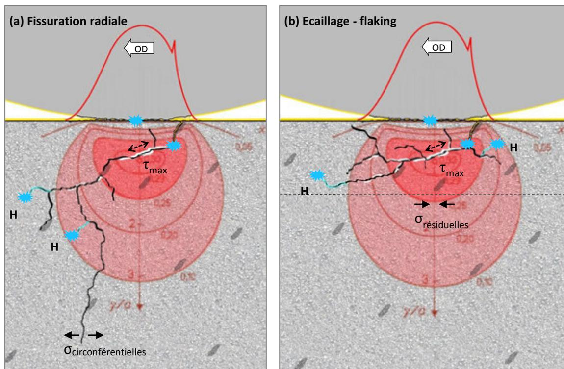
**Figure 12:** Schéma de la propagation des WEC due à la fragilisation par hydrogène localisée en pointe de fissures : (a) fissuration et rupture radiale des composants trempés et sujet à des contraintes circonférentielles de traction, (b) écaillage (ou flaking) des composants sujet à des contraintes résiduelles compressives, par exemple en cas de cémentation, qui contraignent les WEC proche de la surface.
