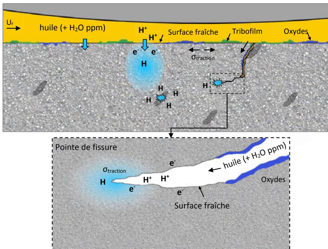
**Figure 11:** Schéma de l'absorption d'hydrogène dans l'acier: le lubrifiant et/ou les molécules d'eau présentes se décomposent électrochimiquement au contact de surface fraîche métallique en extrême surface ou en pointe de microfissures, libérant ainsi l'hydrogène hautement diffusible qui est en partie piégé dans les interstices et défauts comme les inclusions.
