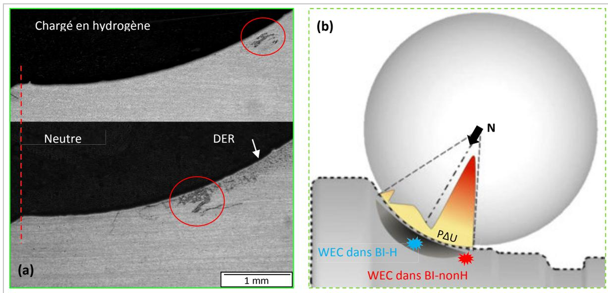
**Figure 8:** Position différente des WEC sur les BI chargés en hydrogène ou non.
