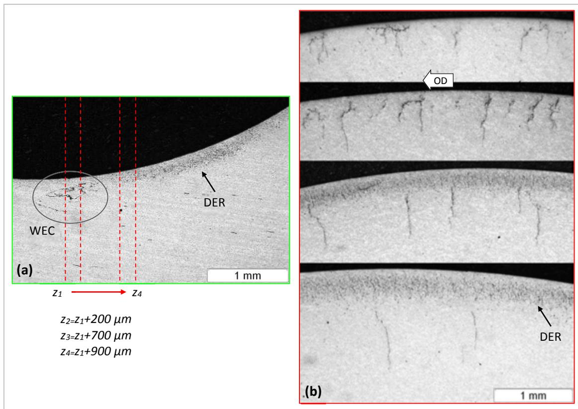
**Figure 7 :** Coupe axiale d'une BI neutre (a) dévoilant la position typique des WEC à l'extrémité inférieure de la zone de contact (repérée par les DER) et la position approximative des 4 coupes circonférentielles obtenues par polissages successifs de la même BI (b).
