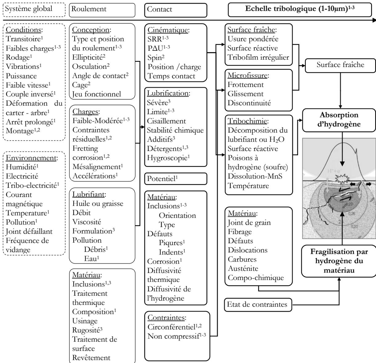
Figure 13: Aperçu global des paramètres influents sur la formation des WEC de l'échelle macroscopique à l'échelle tribologique basé sur l'occurrence de WEC dans: <sup>1</sup> les roulements d'éoliennes, <sup>2</sup> ACBB et <sup>3</sup> CRTB.
