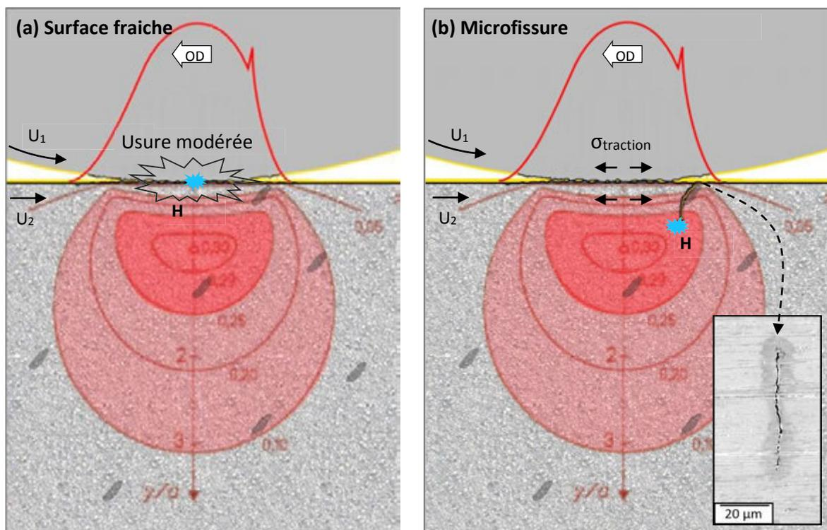
**Figure 10:** Schéma des mécanismes d'initiation des WEC par la formation de surface fraîche soit (a) directement au niveau de la piste en extrême surface en cas d'usure modérée et/ou de tribofilm hétérogène, soit (b) via l'ouverture d'une microfissure permettant au lubrifiant d'atteindre les flancs de fissure.
