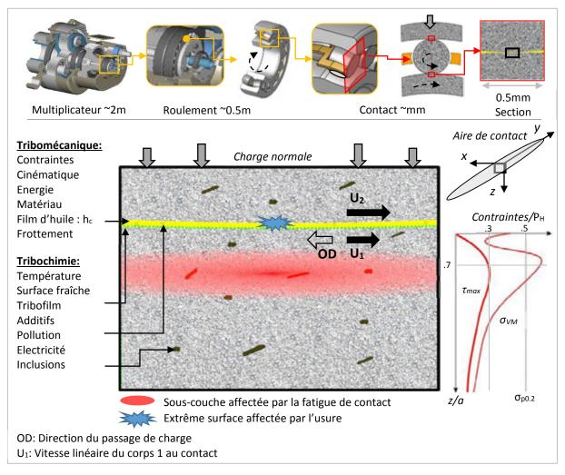
Figure 3 : Schéma général d'un contact tribologique dans un roulement considérant les paramètres tribomécaniques et tribochimiques affectant la durée de vie du contact et donc du roulement.
