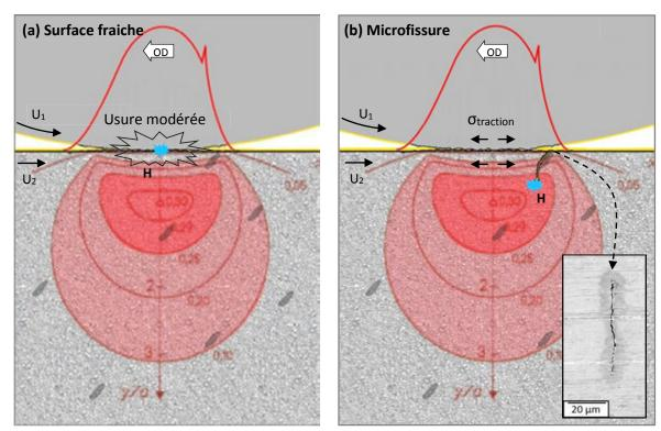
Figure 10: Schéma des mécanismes d'initiation des WEC par la formation de surface fraîche soit (a) directement au niveau de la piste en extême surface en cas d'usure modérée et/ou de tribofilm hétérogène, soit (b) via l'ouverture d'une microfissure permettant au lubrifiant d'atteindre les flancs de fissure.
