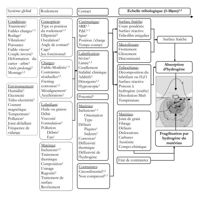
**Figure 13**: Aperçu global des paramètres influents sur la formation des WEC de l'échelle macroscopique à l'échelle tribologique basé sur l'occurrence de WEC dans: ¹ les roulements d'éoliennes, ²ACBB et ³CRTB.
