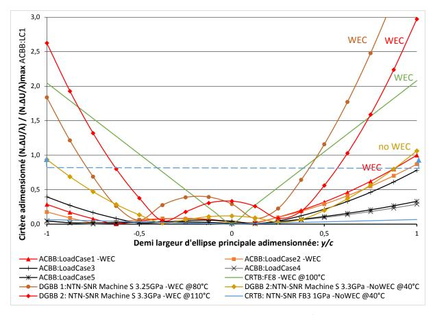
**Figure 14**: Ratio du critère énergétique par le paramètre de lubrification  $N.\Delta U/\lambda$  pour différents roulements.
