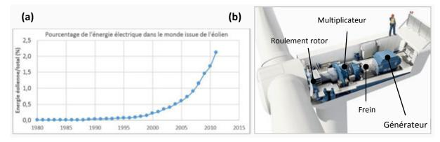
**Figure 1**: (a) Pourcentage de l'énergie électrique dans le monde issue de l'éolien (données accessibles [1]); (b) Structure typique de la nacelle d'une éolienne multi-MW (ZF transmission, www.zf.com).
