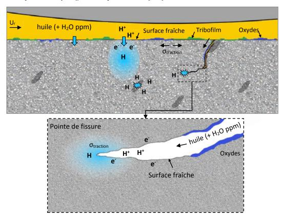
Figure 11: Schéma de l'absorption d'hydrogène dans l'acier: le lubrifiant et/ou les molécules d'eau présentes se décomposent electrochimiquement au contact de surface fraîche métallique en extrême surface ou en pointe de microfissures, libérant ainsi le l'hydrogène hautement diffusible qui est en partie piégé dans les interstices et défauts comme les inclusions.
