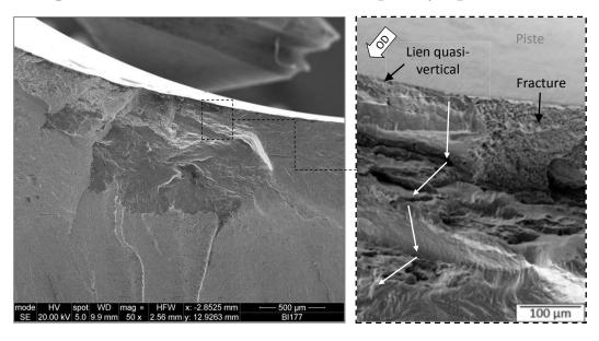
**Figure 9** : Fratographie d'une BI avec un grossissement au MEB sur le lien avec la surface dévoilant un faciès de clivage radicalement différent et préxistant par rapport à la fracture globale.
