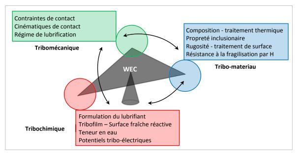
**Figure 16:** Le mécanisme tribologique à l'origine des WEC nécessite un subtil équilibre instable entre les paramètres mécaniques, matériau et tribochimique qui interagissent fortement.
