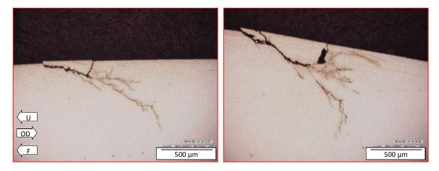
**Figure 15**: Coupes circonférentielles du disque cylindrique lent après essai avec un lubrifiant dont la formulation contient des détergents de type Sulfonate de Calcium.
