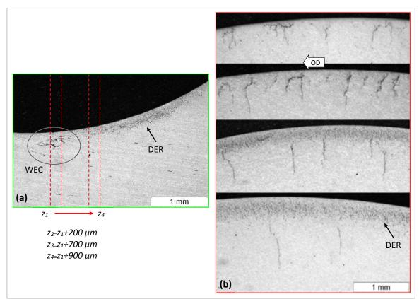
**Figure 7 :** Coupe axiale d'une BI neutre (a) dévoilant la position typique des WEC à l'extrémité inférieure de la zone de contact (repérée par les DER) et la position approximative des 4 coupes circonférentielles obtenues par polissages successifs de la même BI (b).
