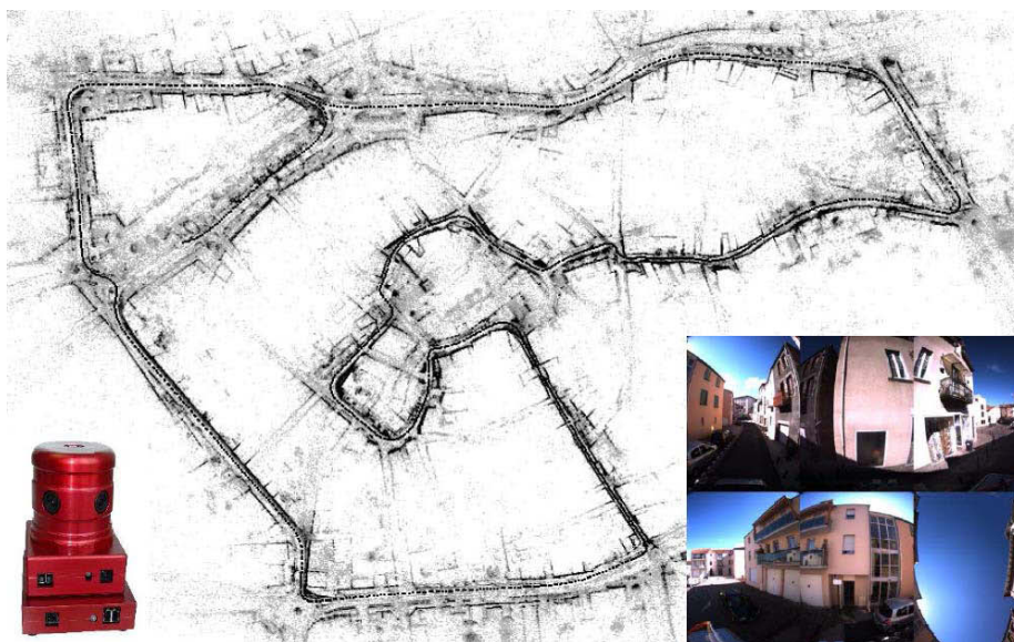
FIGURE D.2 – Vue globale du nuage des points 3D calculée à partir du jeu de données réelles, ainsi qu'un exemple d'une image produite par la caméra utilisée.
