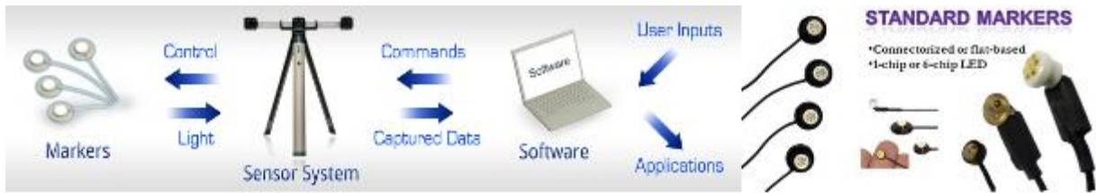
Figure 28 La capture optique avec marqueurs actifs par la société PTX (Phoenix Technologies Incorporated). A gauche le schéma de fonctionnement des systèmes, à droite des exemples de marqueurs photosensibles 11
