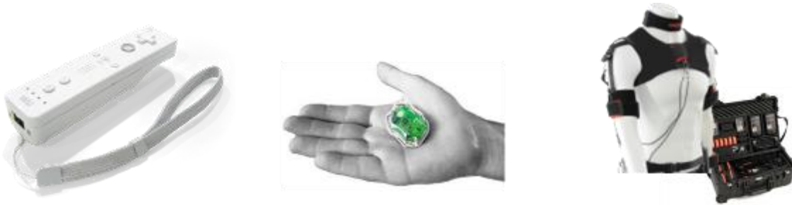
Figure 26 La capture inertielle. A gauche la Wiimote de Nintendo 5 , au milieu le MotionPod 6 de la société MOVEA, le MVN BIOMECH de Xsens 7
