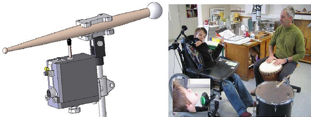
Figure 4 Prototype du boîtier (à gauche) et utilisation de la MEM en situation musicale (à droite)
