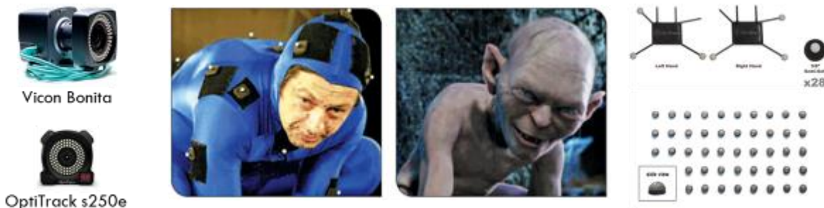
Figure 27 La capture optique avec marqueurs passifs. A gauche des exemples de caméras 8 , au milieu un exemple d'application pour la réalisation de film d'animation 9 , à droite des exemples de marqueurs 10
