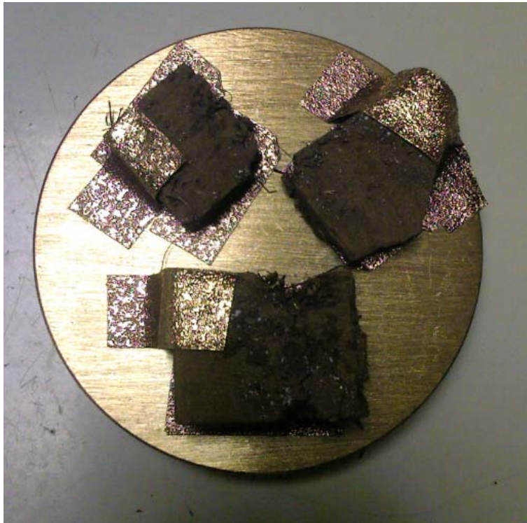
FIG. 2.7 – Eprouvettes de plâtre métallisées et prêtes à l'observation au MEB
