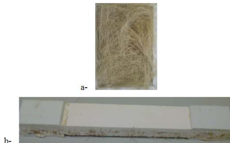
FIG. 3.33 – Influence de l'architecture du RC : a- fibres non orientées dans le moule b- éprouvette de traction
