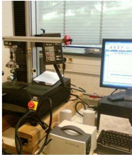
FIG. 3.15 – Comportement à l'interface : machine de traction des fibres INSTRON
