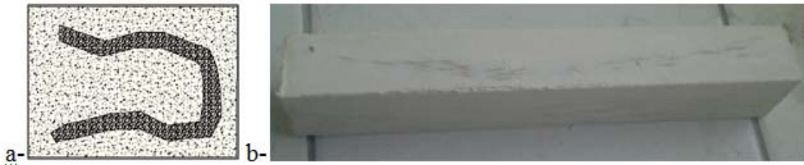
FIG. 3.49 – Comportement en flexion: éprouvette de flexion à renfort tissé a- configuration possible du tissu dans le matériau, b- éprouvette de flexion du composite plâtre/fibres
