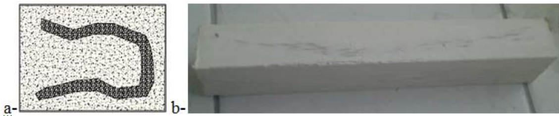
FIG. 3.49 – Comportement en flexion: éprouvette de flexion à renfort tissé a- configuration possible du tissu dans le matériau, b- éprouvette de flexion du composite plâtre/fibres
