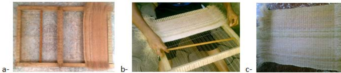
FIG. 3.45 – Fabrication du tissu de RC: a- métier à tisser b-opération de tissage en cours c- tissu de RC
