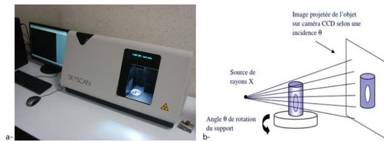
FIG. 2.10 – Principe de la micro-tomographie a- Micro-tomographe SkyScan Model 1174 b- principe de prise d'images à reconstituer
