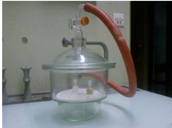
FIG. 2.6 – Mesure des masses volumiques des fibres: agitation vortex dans un dessiccateur pour évacuation des microbulles des fibres
