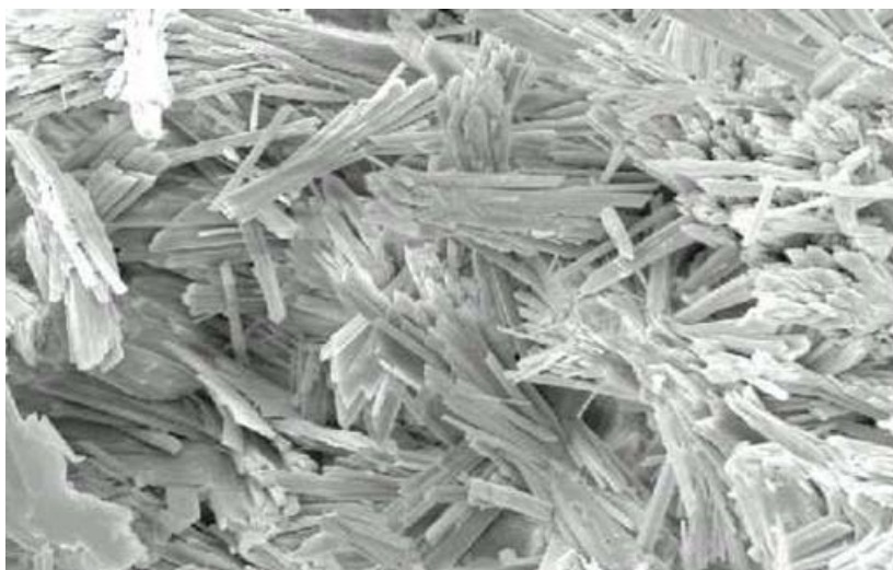
FIG. 1.17 – Enchevêtrement des cristaux du plâtre pris gâché à E/P = 0,8 (Image MEB d'un faciès de rupture - 20\mu m )
