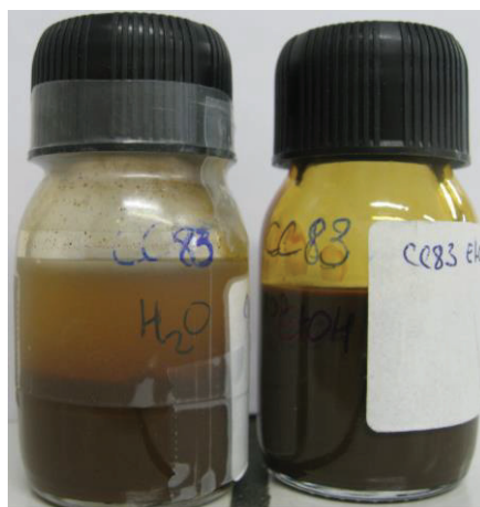
Figure 24 : Oxydes de fer modifiés par du MPS dispersé dans de l'eau (à gauche) et dans de l'éthanol (à droite)
