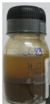
Figure 18 : Photo d'une suspension d'oxydes de fer modifiés MPS par le procédé hydro-alcoolique puis redispersés dans l'eau
