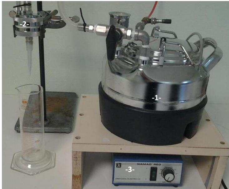
*Figure II-6 : Pilote de filtration frontale (-1- réservoir d'alimentation, -2- cellule de filtration, -3- agitateur magnétique).*
