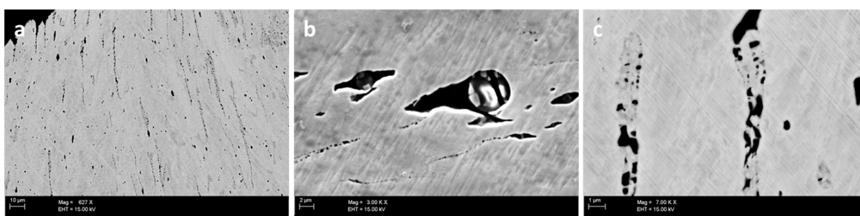
FIGURE 18: Micrographies MEB d'une coupe longitudinale à mi-épaisseur dans une éprouvette de traction à l'état détensionné rompue dans l'acier 308L : a- vue globale; b- cavités ayant germées sur des oxides; c- aux interfaces \delta - \gamma .
