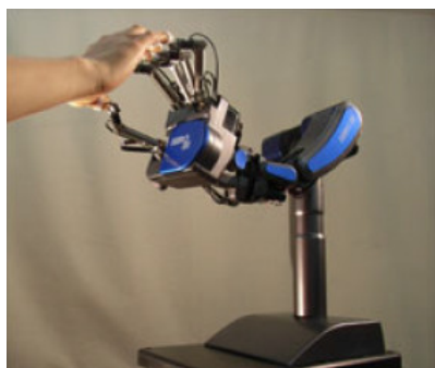
FIGURE 2.20: Interface à cinq doigts HIRO III (ENDO, YOSHIKAWA et KAWASAKI 2010).
