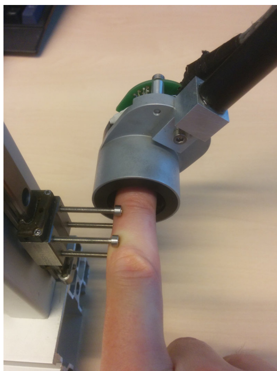
FIGURE 4.8: Banc d'essai pour l'identification des paramètres du modèle unidimensionnel de l'interface (vue de dessus).
