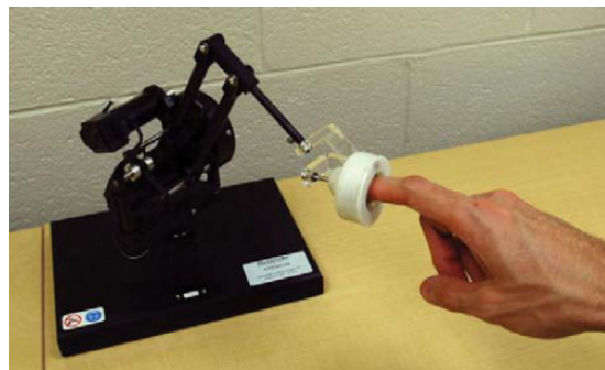
FIGURE 2.29: Interface Touch Thimble (KUCHENBECKER et al. 2008).
