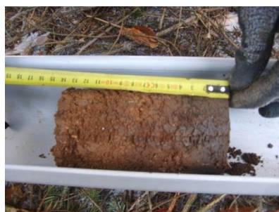
Figure II-8 : Carottage des 15 premiers centimètres du sol.
