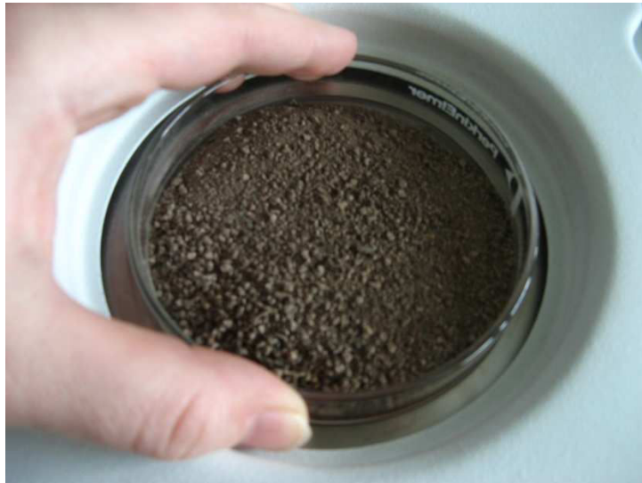
Figure 5.4. Placement de l'échantillon de sol sur une coupelle avant la mesure. Photo : B. Vysloužilová.
