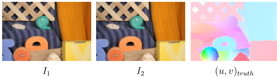
FIGURE 8.4 – Les images I_1 et I_2 sont tirées de la séquence RubberWhale. On présente la vérité terrain du flot optique. Les couleurs représentent la direction du flot, alors que l’intensité est liée à la norme du vecteur.
