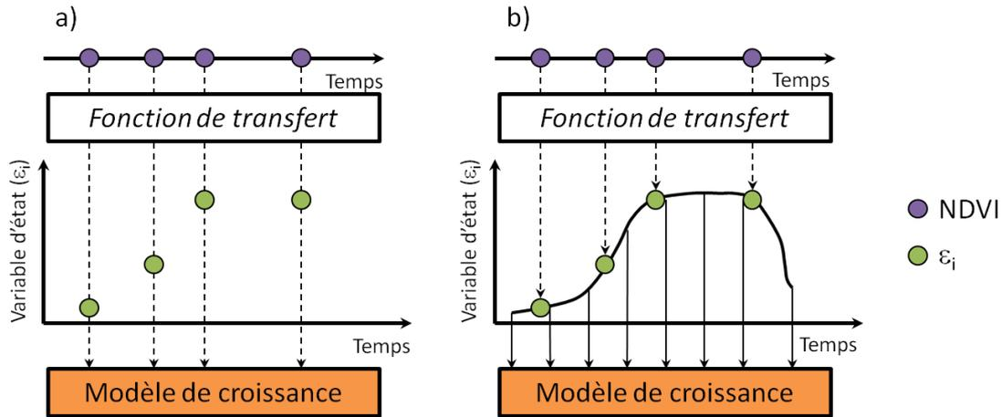
Figure 12. Principe de forçage partiel (a) et complet (b) de la variable d'état  $\varepsilon_i$ . Adapté de Delécolle *et al.* (1992).
