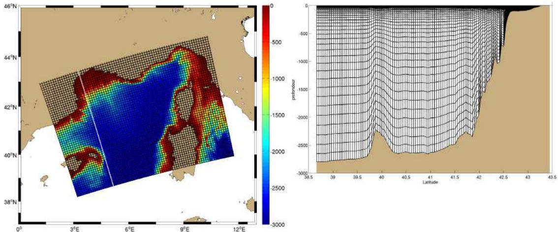
FIGURE 3.1 – *Domaine de calcul avec bathymétrie et maillage. Pour la lisibilité de la figure, la grille dessinée est grossière. Chaque maille représentée équivaut à 10\*10 mailles. Une coupe le long de la ligne blanche montre le maillage vertical avec une résolution 5 fois moindre.*
