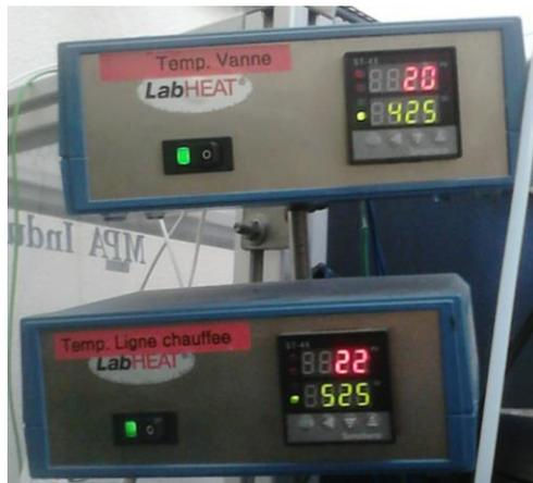
Figure 28 : Contrôleurs de température des rubans chauffants de la vanne HT et de la ligne HT.
