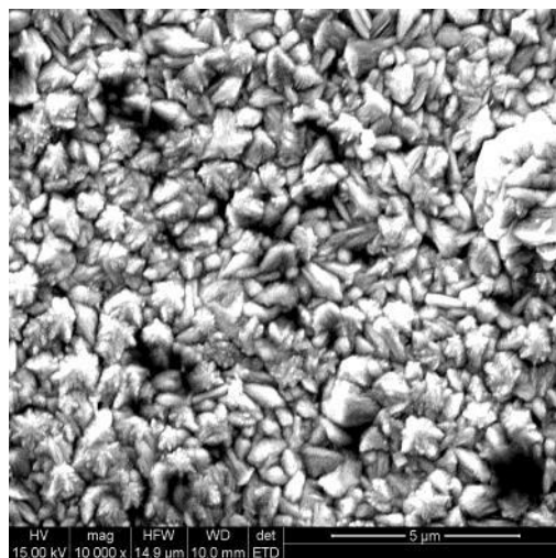
Figure 17: Dépôt de HfC obtenu avec un rapport HfCl 4 /H 2 =17 à 1050°C sous 15kPa en 3h30 avec un débit d'argon de 900 sccm [Szwedek 2011]
