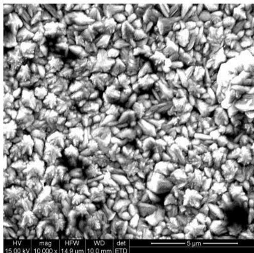
Figure 17: Dépôt de HfC obtenu avec un rapport HfCl<sub>4</sub>/H<sub>2</sub>=17 à 1050°C sous 15kPa en 3h30 avec un débit d'argon de 900 sccm [Szwedek 2011]
