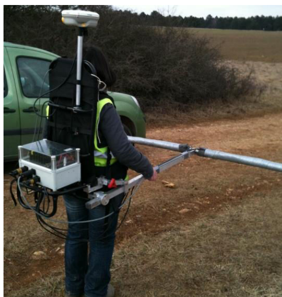
Figure 3 : Dispositif de mesure magnétique utilisé sur le chantier de Kembs
