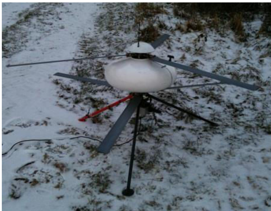
Figure 12 : Drone Infotron IT180 équipé du magnétomètre Bartington
