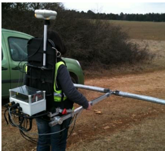
Figure 13 : Système de mesure classique dit « perche » ou « sac à dos »
