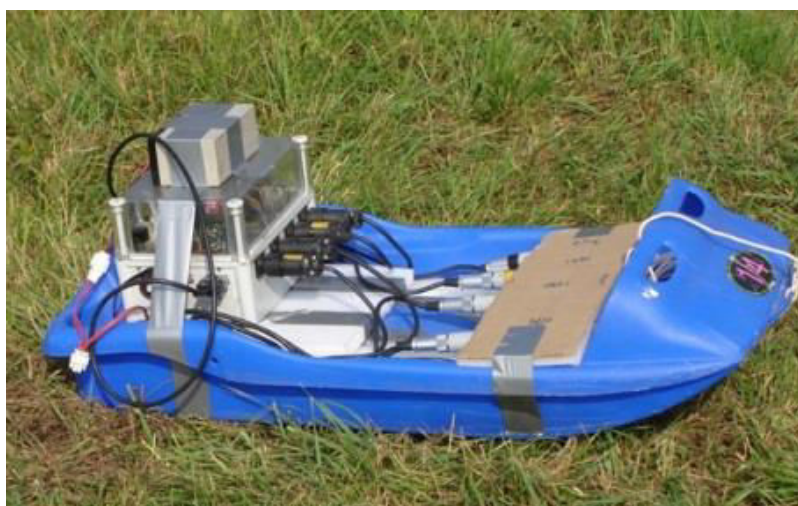
Figure 16 : Système de mesure haute définition dit « luge »
