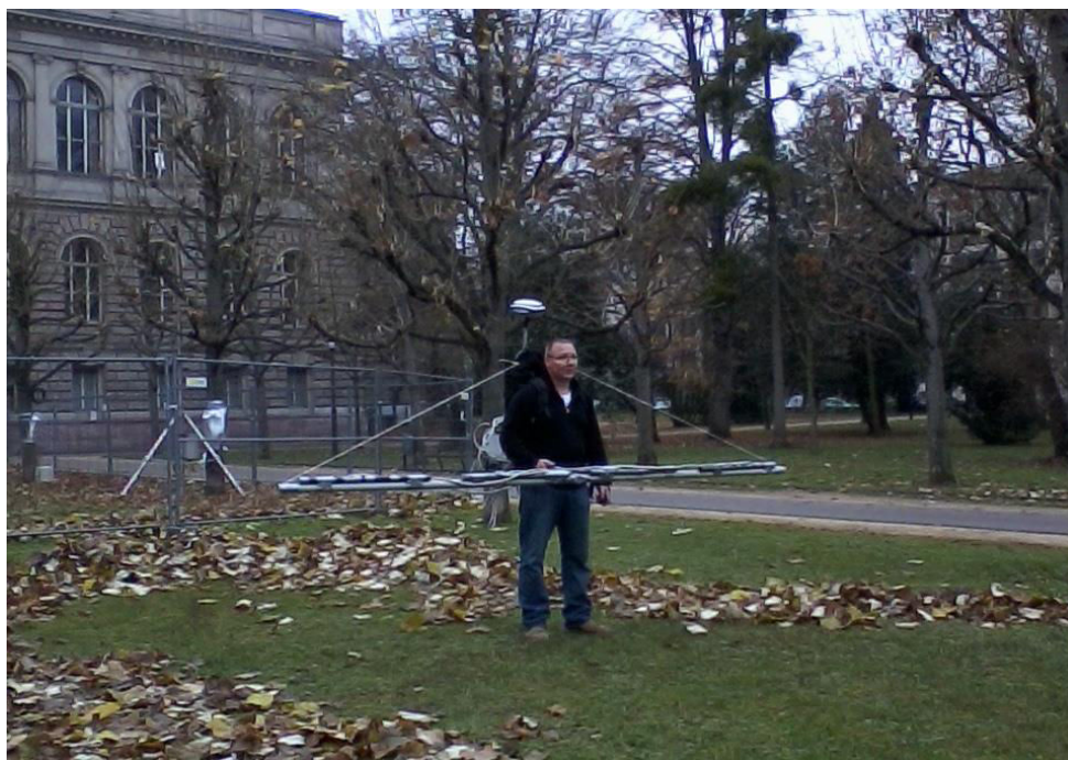
Figure 14 : Système de mesure classique dit « perche » ou « sac à dos » avec huit capteurs
