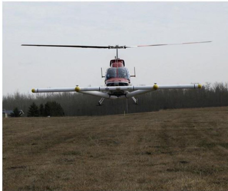
Figure 27 : Dispositif de mesure du champ magnétique très basse altitude (d'après Billings et Wright 2010)
