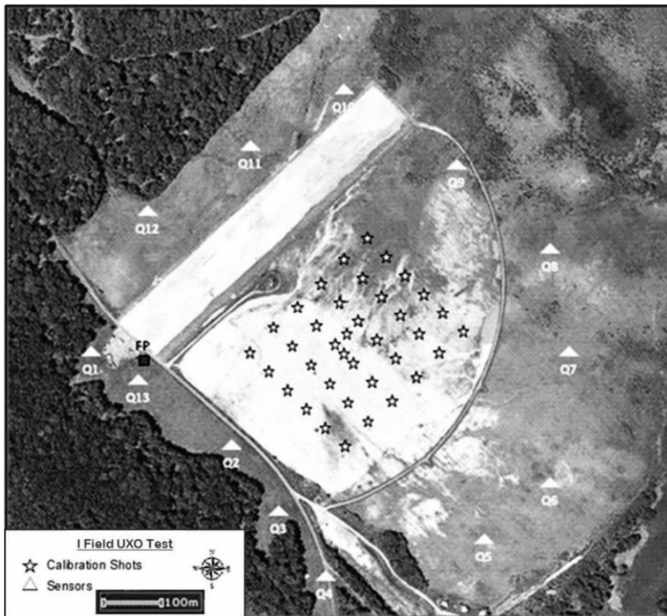
Figure 4 : Site test de la sismique acoustique. Les capteurs (Q1 à Q12) entourent la zone de tir et ont été étalonnés par des tirs de calibration (étoiles) (d'après VanDeMark et al., 2013)
