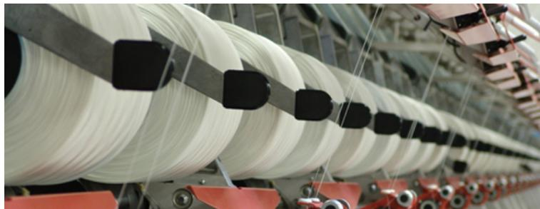
FIGURE 1.2 – Bobines de câbles textiles utilisés dans le pneu ([www.toutsurpneu.michelin.com](http://www.toutsurpneu.michelin.com)).
