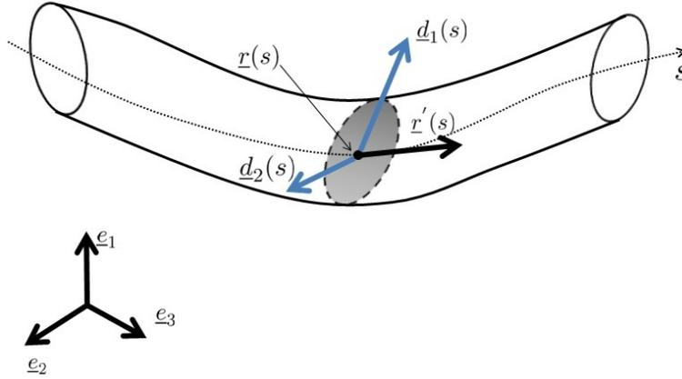
FIGURE 2.4 – Modèle de poutre à cinématique enrichie
