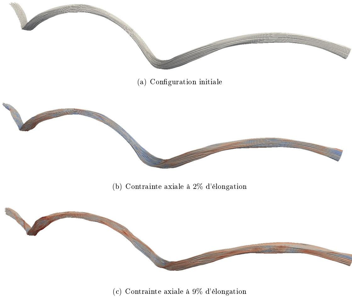
FIGURE 6.15 – Simulation de la traction à l'échelle microscopique sur le paquet de filaments associé à la marofibre choisie.
