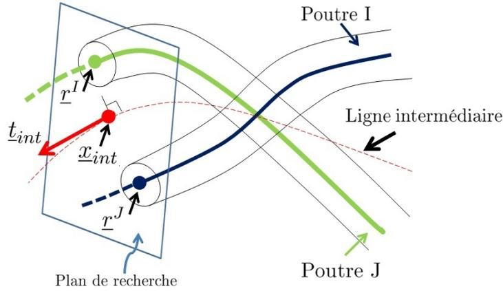
FIGURE 3.10 – Détermination des sections candidates au contact
