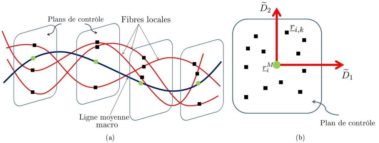
FIGURE 6.7 – Méthode d'imposition des quantités macroscopiques à l'échelle locale.
