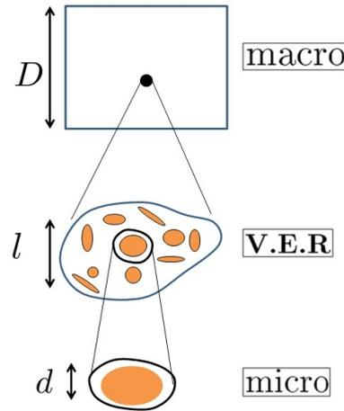
FIGURE 4.11 – Séparation d'échelles pour la théorie de l'homogénéisation.
