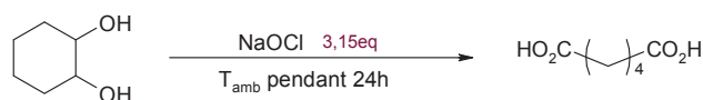
Figure 62 – Etude du clivage oxydant du cyclohexanediol en présence de Javel et de métaux de transition
