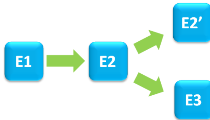
FIGURE 4.16 – Le modèle multi-états de dégradation (MED)
