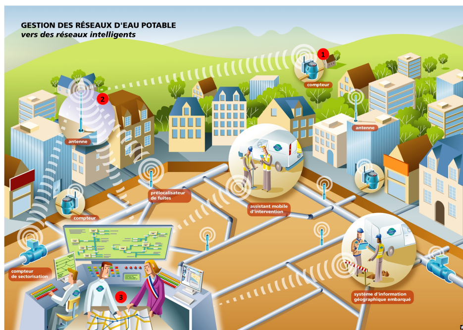
FIGURE 2.8 – Le fonctionnement du télérelevé des compteurs d'eau
