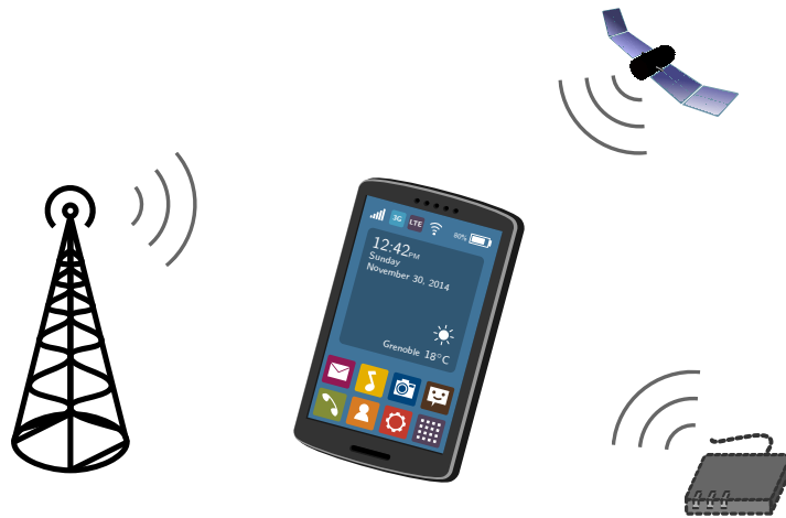
FIGURE 2 – Terminal mobile multi-standard en réseau avec plusieurs sources différentes (station de base, modem, satellite)
