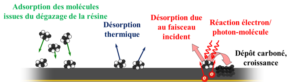
Figure 2-3 : Représentation schématique du processus de dégradation des optiques de projection par croissance de la couche carbonée en surface des optiques sous l'effet du flux de photons ou d'électrons
