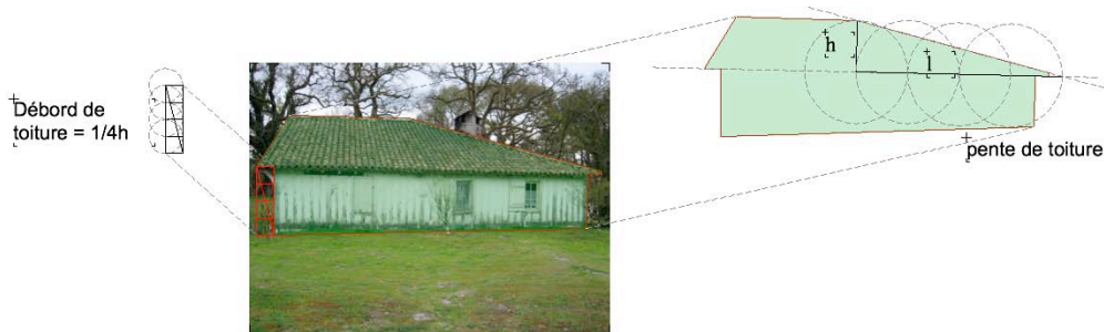
Figure 67, Aerial landais, débord de toiture et pente de toiture.
