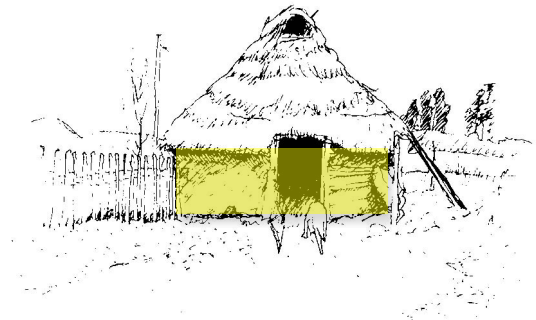
Figure 23 Ruca Nagche, proportion hauteur de toiture et hauteur des murs, 2/3 correspondent à la toiture et 1/3 correspond à la hauteur des murs.
