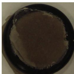
Figure 10 : Matériau composite à base de 55% Bis-GMA / 45% TEGDMA + 50% silice II
