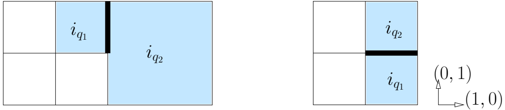
FIGURE 4.4 – Description du couple (i_q^1, i_q^2) . La q^{\text{ième}} interface est représentée en épaisseur. Sur l'image de gauche, elle est verticale et le premier indice du couple est à sa gauche. Sur l'image de droite, elle est horizontale, et le premier indice du couple est en bas.
