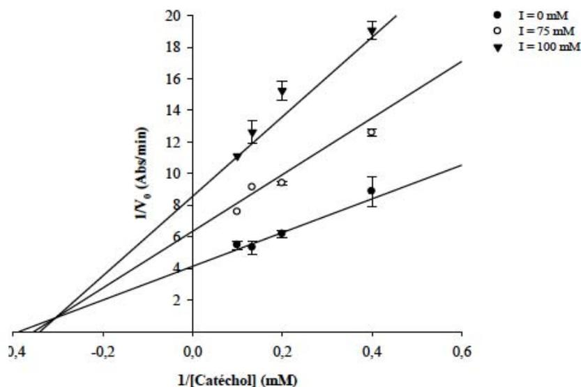
**Figure 51:** Les graphiques de Lineweaver-Burk de l'inhibition de l'activité de la PPO de la truffe du désert sur le pyrocatechol par le fluorure de sodium. Concentrations de fluorure de sodium sont : 0 (●), 75 (○) et 100 mM (▲).
