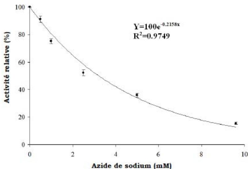
**Figure 39:** Effet de la concentration de l'azide de sodium sur la l'oxydation de pyrocatechol par la PPO de champignon de couche. Les conditions d'essai : 25°C, 2.0 ml de milieu réactionnel contient 0.1 M de tampon  $K_2HPO_4$ - $KH_2PO_4$  (pH 7.0), 0.4 mM de pyrocatechol, et 10  $\mu$ L de la PPO de champignon de couche.
