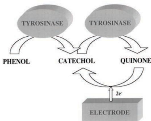
**Figure 12:** L'ortho-quinone (formée par l'oxydation enzymatique du catéchol) est réduite électrochimiquement en catéchol. Ce courant de réduction est mesuré et permet de doser la quantité d'ortho-quinone enzymatiquement formée.
