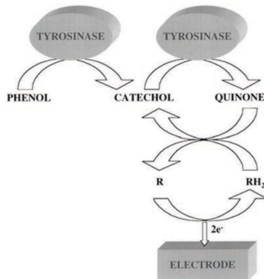
**Figure 13 :** L'ortho-quinone (formée par l'oxydation enzymatique du catéchol) est réduite en catéchol via l'oxydation du médiateur réduit ( $RH_2$ ) en médiateur oxydé (R). La forme R du médiateur est alors réduite sur l'électrode. Ce courant de réduction est mesuré et permet de doser la quantité d'ortho-quinone enzymatiquement formée.
