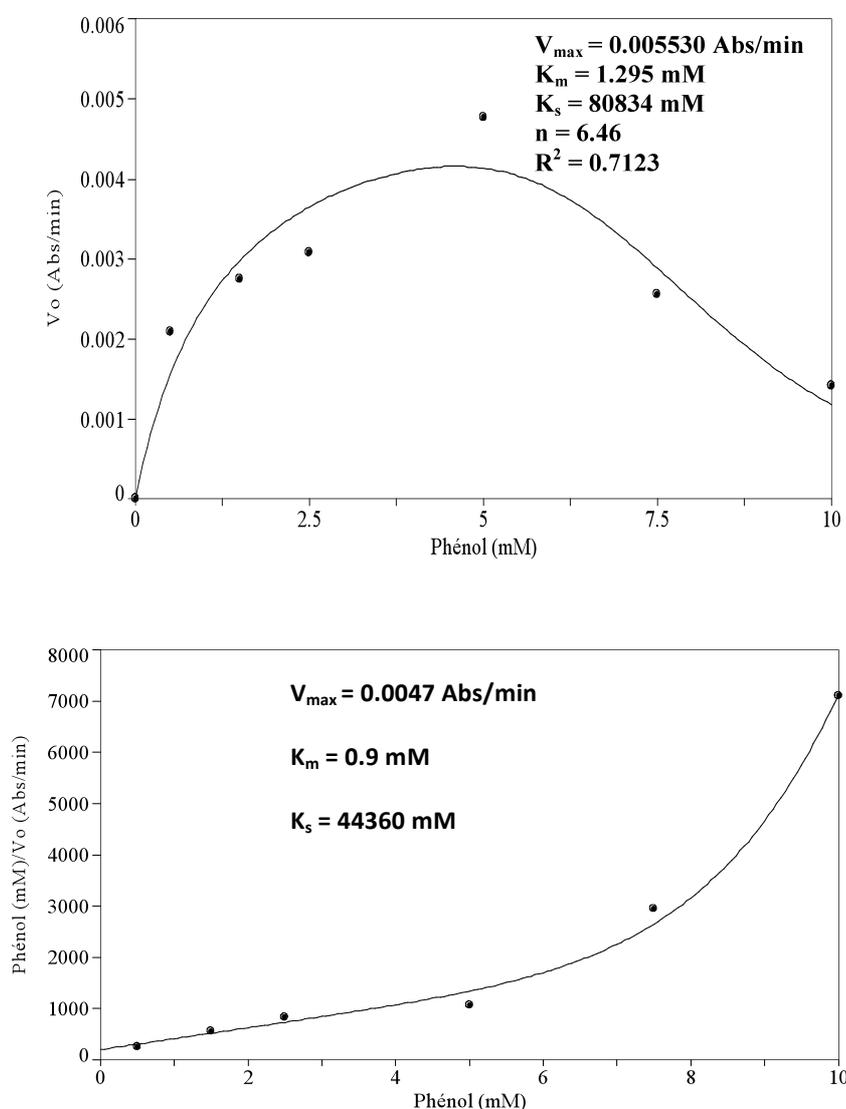
**Figure 65:** Etude de l'effet de la concentration du substrat sur la vitesse initiale de l'oxydation du phénol par la PPO immobilisée dans le gel d'alginate de calcium à 2.5% (diamètre des billes 2.6 mm, pH 6 (tampon acétate de sodium 0.05 M), et à 35°C) (haut) Représentation graphique de Michaelis-Menten ; (bas) Représentation graphique de Lineweaver-Burk.
