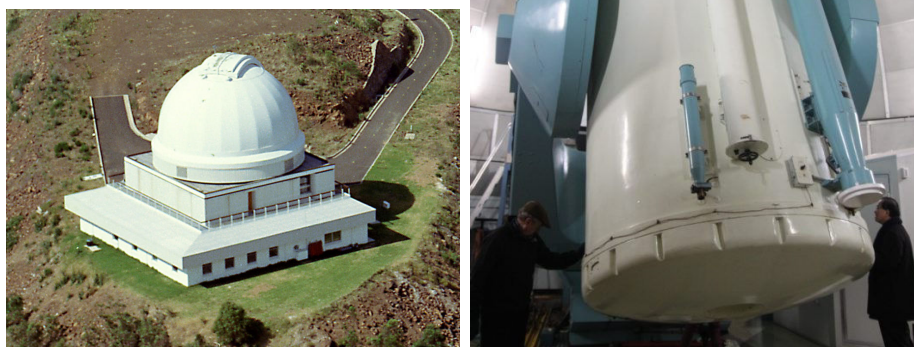
FIGURE 2.1 – A gauche : vue de la coupole du télescope UKST situé à Siding Spring, Australie. A droite : le télescope UKST de 1.2m, les plaques de fibres sont montées à la main dans le plan focal par le dessous du télescope.
