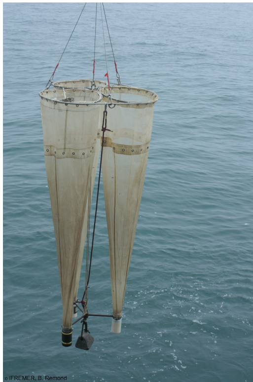
FIGURE 3.2 – L'échantillonneur WP2 est composé de 3 filets identiques de maille 200\ \mu\text{m} . Il est utilisé en profil vertical pour décrire la communauté méso-zooplanktonique.
