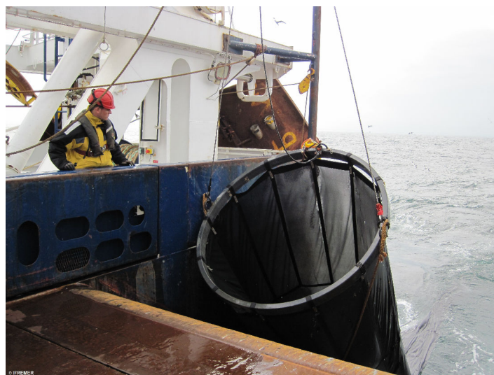
FIGURE 4.30 – Photographie du Midwater Ringnet trawl (MIK) lors de sa mise à l'eau sur le pont arrière du navire Thalassa.
