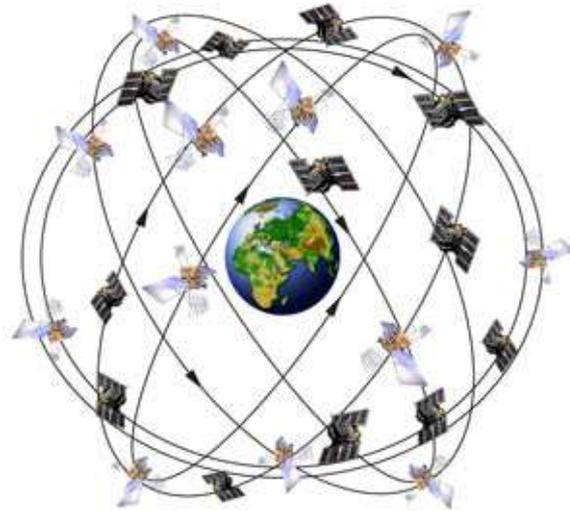
FIGURE 2.4 – Constellation de satellites du GPS
