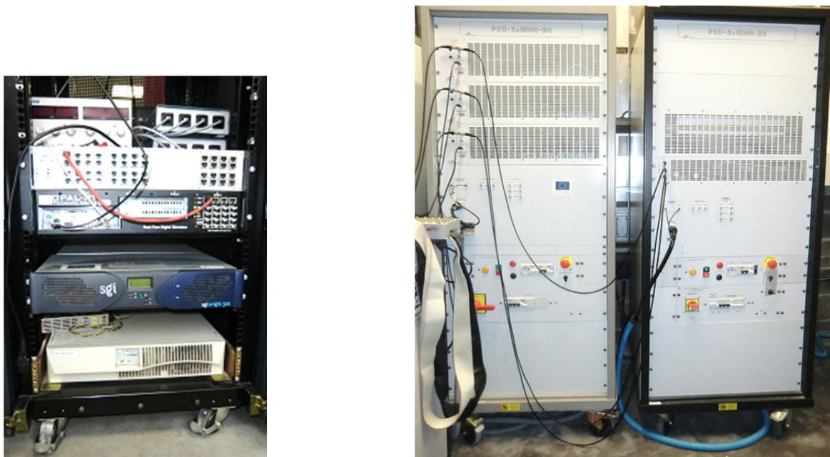
a) Calculateur RT-LAB<sup>®</sup> à cœurs parallèles    b) Amplificateur de puissance (2 x 15kVA)
