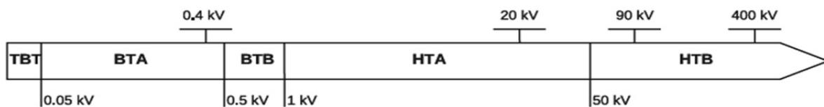
Fig. 1.14. Normalisation des différents niveaux de tension
