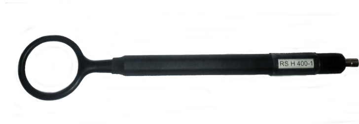
FIG. 3.35 – Sonde LANGER RF-R400-1 utilisée pour la mesure à deux sondes.
