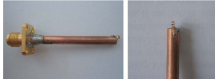
FIG. 2.5 – Bobinage ayant une résolution spatiale en dessous du millimètre [Peeters et al., 2007].
