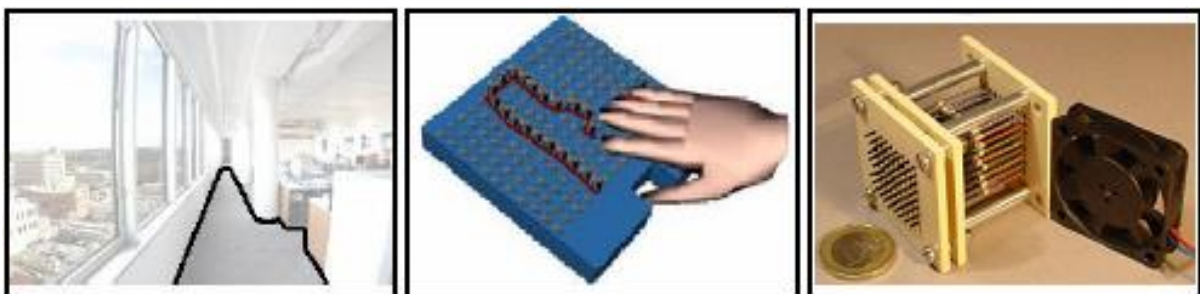
Figure 3.8 : De gauche à droite: une image de l'environnement, la représentation tactile de l'environnement, et l'interface tactile (TactiPad, ISIR, Université Paris 6).
