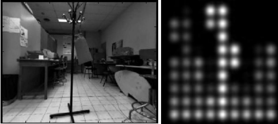
Figure 3.9 : (à gauche) Une scène réelle ; (à droite) la restitution de cette scène par le stimulateur rétinien.
