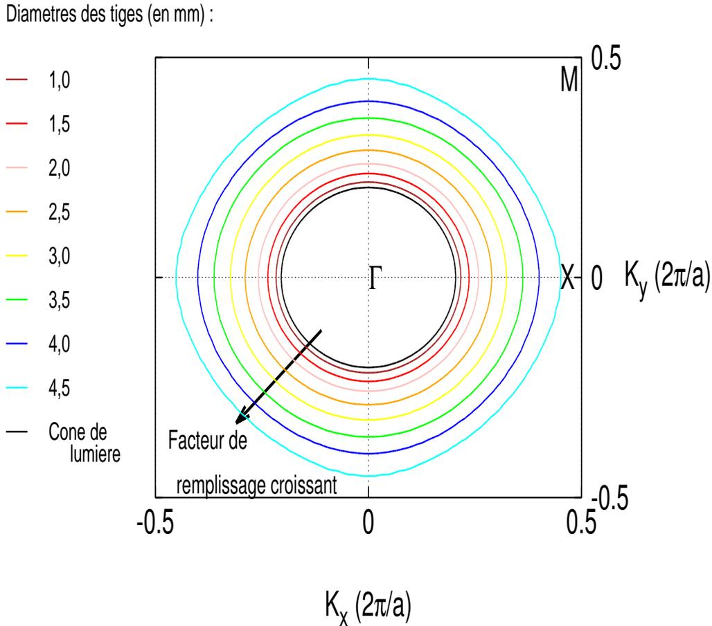
FIGURE 3.29 – Courbes isofréquences à  $\nu = 9$  GHz pour différents rayons de tiges d’alumine dans l’air. La maille élémentaire est carrée de période  $a = 7$  mm ( $a/\lambda = 0,21$ ). La polarisation est transverse magnétique (TM).
