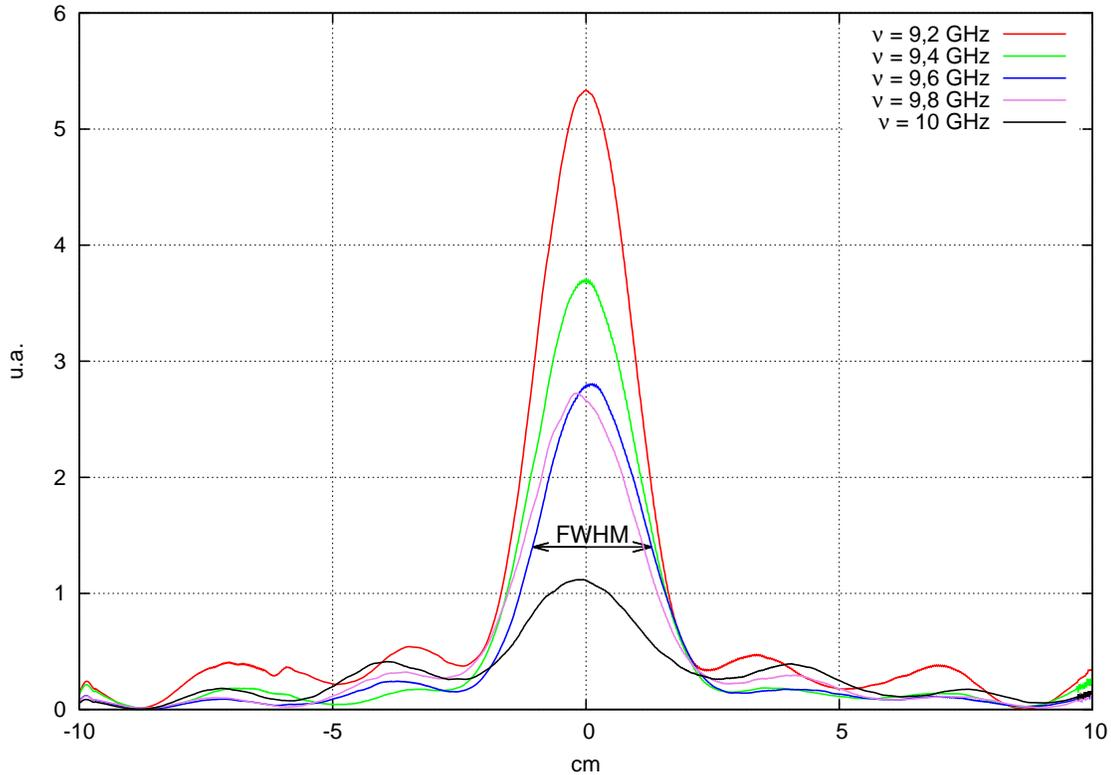
FIGURE 3.21 – [Expérimentation] Coupes effectuées à partir des résultats expérimentaux au niveau du plan focal lorsqu’une onde plane sinusoïdale traverse la lentille à gradient d’indice positif pour différentes fréquences situées autour de la fréquence de  $\nu = 9,6$  GHz. Pour une meilleure lisibilité, les courbes obtenues ont été filtrées avec l’algorithme de Savitzky-Golay [142]. On obtient une largeur à mi-hauteur d’environ  $0,75 \cdot \lambda$ .
