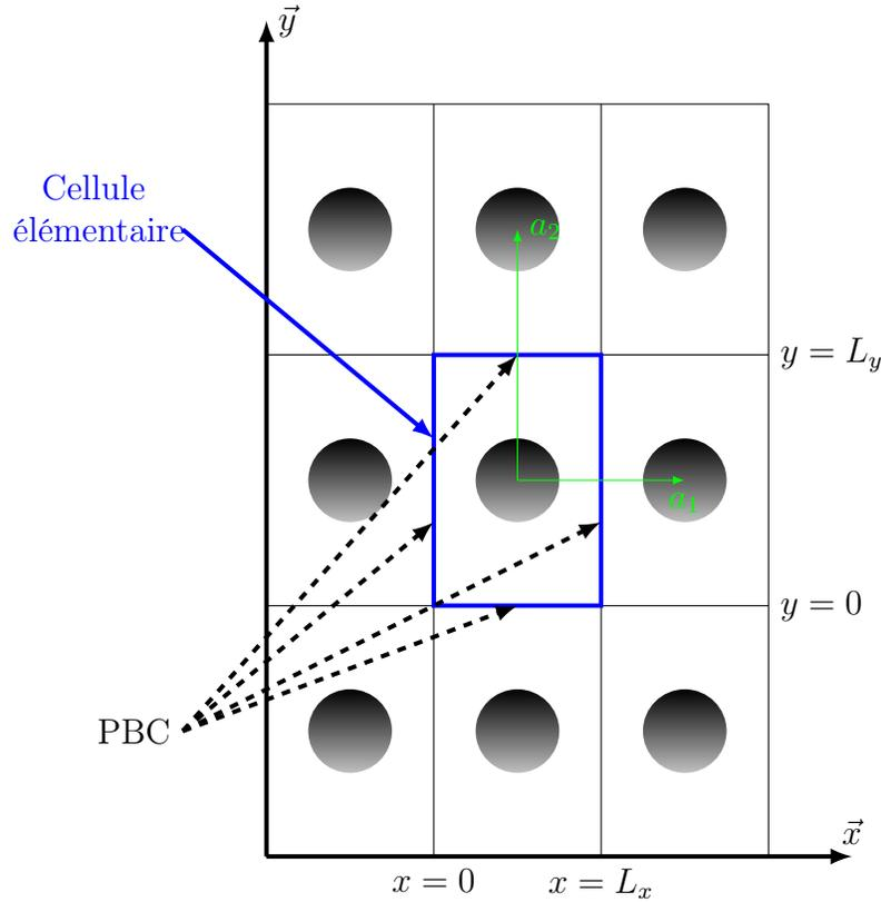
FIGURE 2.2 – Application des conditions périodiques aux limites (*PBC : Periodic Boundary Conditions*) issues du théorème de Bloch à un cristal photonique constitué de tiges (diélectriques ou métalliques) au sein d’une maille rectangulaire de côtés  $L_x$  et  $L_y$ . Le théorème de Bloch permet de simuler une structure de dimension infinie dans deux directions de l’espace (suivant  $\vec{x}$  et  $\vec{y}$ ).  $a_1$  et  $a_2$  représentent les vecteurs de base du réseau direct.
