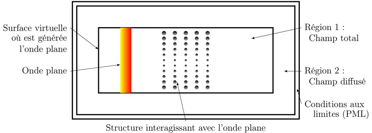
FIGURE 2.8 – Représentation graphique de la séparation d'un domaine de simulation FDTD en deux régions distinctes : la zone de champ total et la zone de champ diffusé. Ces deux zones sont reliées entre elles par une surface virtuelle non physique d'où l'onde plane est générée.
