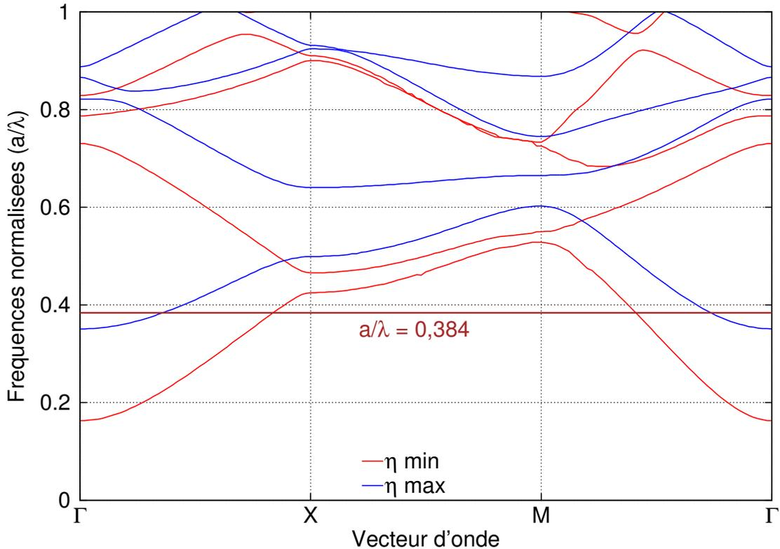
FIGURE 3.8 – Structures de bandes d'un cristal photonique à maille carrée de pas  $a = 12$  mm à pistes métalliques sur substrat diélectrique. Les deux structures de bandes pour les deux facteurs de remplissage extrêmes utilisés sont représentées. La ligne horizontale marron indique la fréquence de fonctionnement ( $a/\lambda = 0,384$ ) située dans la première bande permise, où les courbes iso-fréquences sont circulaires. La polarisation est transverse magnétique (TM).
