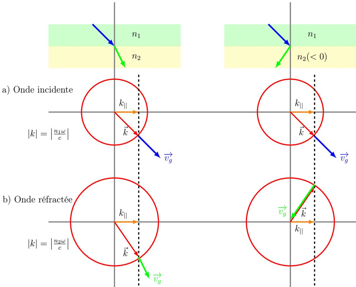
FIGURE 1.10 – Schémas montrant le principe de conservation de la composante tangentielle à l’interface entre deux milieux d’indices  $n_1$  et  $n_2$  différents, tels que  $|n_2| > |n_1|$  et isotropes : les courbes iso-fréquences sont circulaires pour les deux milieux. À gauche : cas conventionnel. À droite : cas de la réfraction négative. Tiré de [51].
