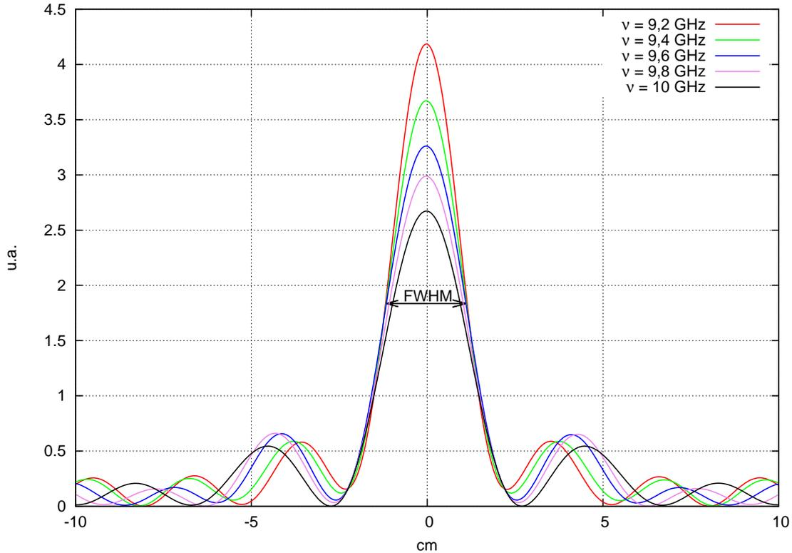
FIGURE 3.15 – [Simulation] Coupes effectuées au niveau du plan focal lorsqu’une onde plane sinusoïdale traverse la lentille à gradient d’indice positif pour différentes fréquences placées autour du point de fonctionnement optimal à la fréquence de  $\nu = 9,6$  GHz. Les courbes ont toutes la forme d’un sinus cardinal dont la largeur à mi-hauteur vaut  $FWHM \approx 0,78 \cdot \lambda$ .
