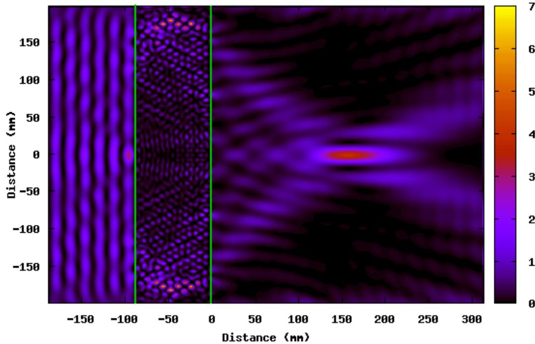
FIGURE 3.25 – [Simulation] Cartographie de la valeur moyenne du champ  $E_z^2$  sur une période ( $\overline{E_z^2}$ ) lorsqu'une onde plane sinusoïdale incidente à  $\nu = 9$  GHz traverse la lentille à gradient d'indice négatif. La lentille est délimitée par les deux traits verts verticaux. La distance focale est obtenue en relevant la valeur maximale de  $\overline{E_z^2}$  au niveau de la tâche focale et vaut  $f \approx 16$  cm.
