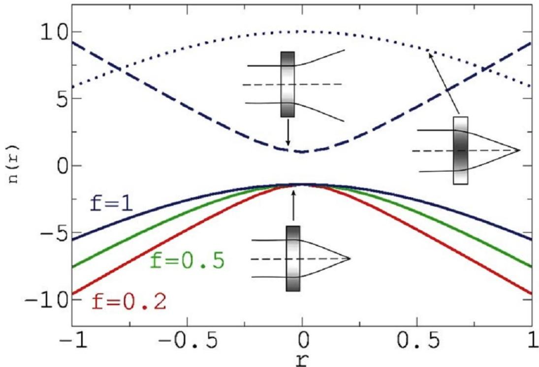
FIGURE 3.5 – Profils d'indice obtenus à partir de l'équation 3.3 pour la lentille plate.  $n_0$  peut aussi bien être positif ou négatif tout comme le gradient du profil qui, s'il est positif, servira à concevoir une lentille divergente. À l'inverse, si ce gradient est négatif, la lentille conçue sera convergente [132].
