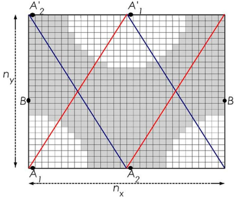
FIGURE 2.3 – Description numérique d’une maille élémentaire d’une structure arrangée périodiquement en mailles triangulaires.  $n_x$  représente le nombre de cellules suivant l’axe  $\vec{x}$  et  $n_y = \frac{\sqrt{3}}{2}n_x$  représente le nombre de cellules suivant l’axe  $\vec{y}$  [114].
