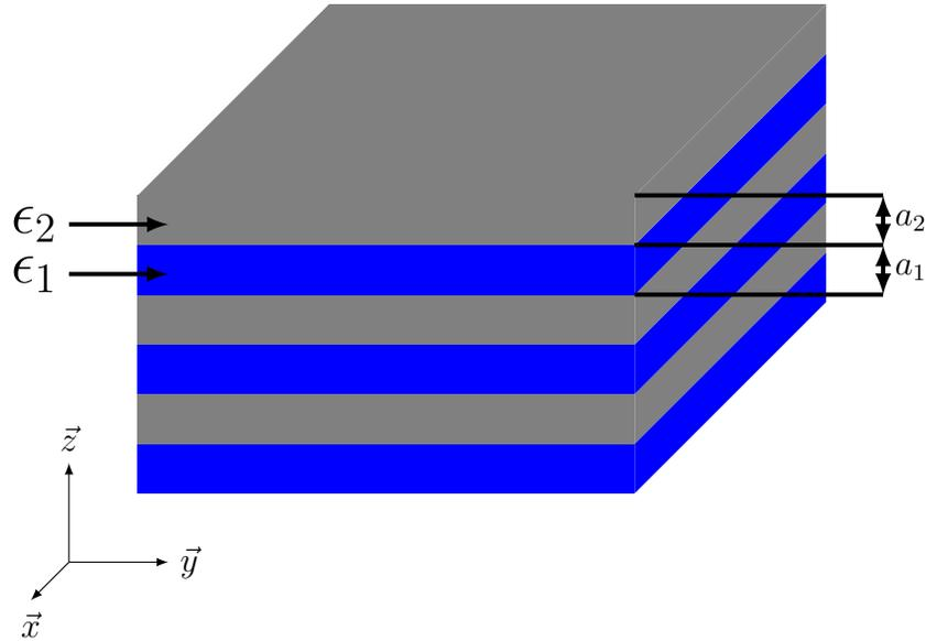
FIGURE 1.1 – Schéma d'un miroir de Bragg constitué d'un empilement de couches d'épaisseurs  $a_1$  et  $a_2$  de permittivités  $\epsilon_1$  et  $\epsilon_2$  ( $\epsilon_1 > \epsilon_2$ ) différentes.
