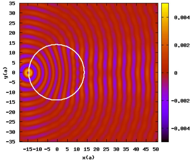
FIGURE 3.33 – [Simulation] Cartographie de la valeur instantanée du champ électrique  $E_z$  (champ électrique parallèle aux tiges d'alumine) lorsqu'une onde cylindrique issue d'une source ponctuelle TM à  $\nu = 9$  GHz située sur la périphérie de la lentille de Luneburg constituée de tiges d'alumine la traverse. Les fronts d'onde en sortie sont plans.
