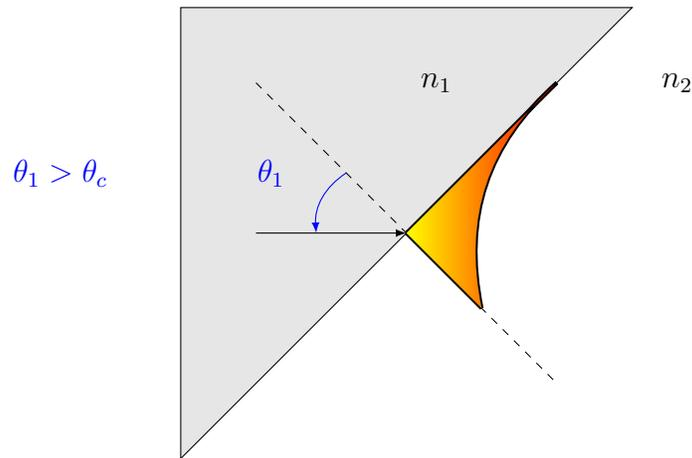
FIGURE 4.2 – À l'interface entre deux milieux d'indices respectifs  $n_1$  et  $n_2$  avec  $n_1 > n_2$ , il y a réflexion totale si  $\theta_1 > \theta_c = \arcsin(n_2/n_1)$ . Dans ce cas, il existe une onde évanescente localisée dans le milieu 2 qui ne se propage pas dans l'espace et qui est périodique dans le temps.
