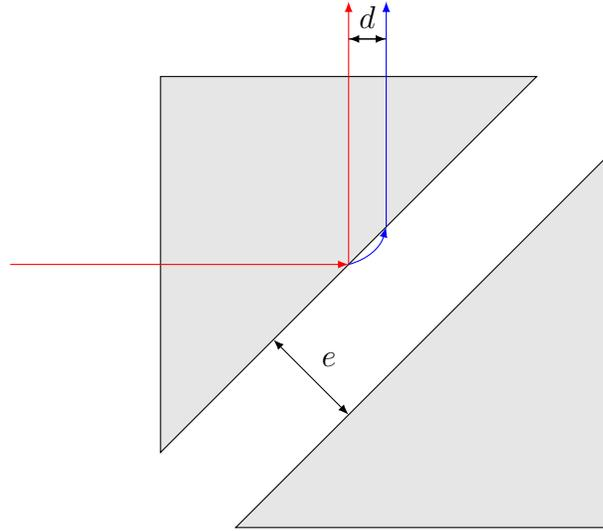
FIGURE 4.8 – Illustration du décalage de Goos-Hänchen : les flèches rouges indiquent le chemin que devrait suivre l'onde incidente après réflexion sur la face de sortie du prisme d'après l'optique géométrique ; la flèche bleue indique le chemin réellement suivi par cette onde en raison de l'effet Goos-Hänchen [190].
