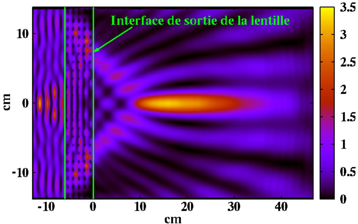
FIGURE 3.13 – [Simulation] Cartographie de la valeur moyenne du champ  $E_z^2$  sur une période ( $\overline{E_z^2}$ ) lorsqu'une onde plane sinusoïdale incidente à  $\nu = 9,6$  GHz traverse la lentille à gradient d'indice positive constituée de pistes de cuivre gravées sur un substrat. La lentille est délimitée par les deux traits verts verticaux. La distance focale est obtenue en relevant la valeur maximale de  $\overline{E_z^2}$  au niveau de la tâche focale et vaut  $f \approx 15$  cm.
