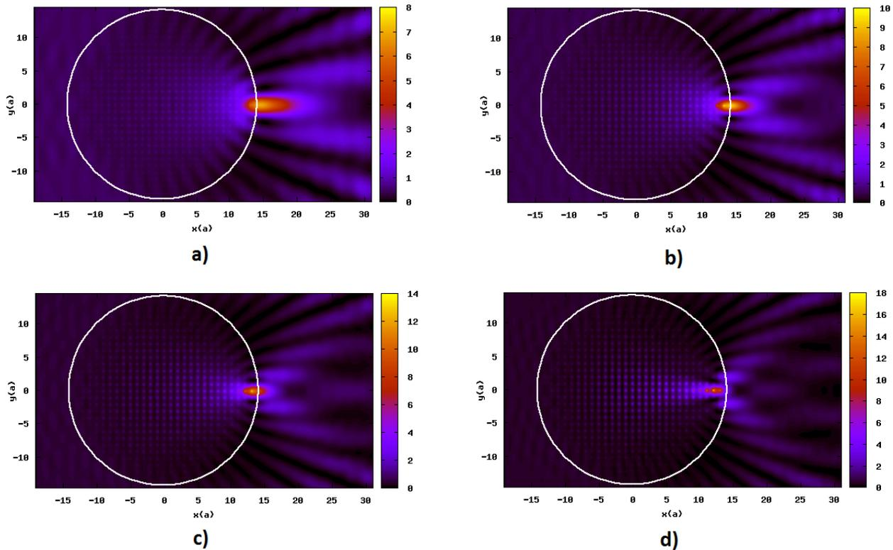
FIGURE 3.34 – [Simulation] Cartographie de la valeur moyenne du champ  $E_z^2$  sur une période ( $\overline{E_z^2}$ ) lorsqu'une onde plane sinusoïdale incidente à a)  $\nu = 8$  GHz; b)  $\nu = 10$  GHz; c)  $\nu = 11$  GHz et d)  $\nu = 12$  GHz traverse la lentille de Lüneburg constituée de tiges d'alumine. Cette onde incidente n'est plus focalisée à la périphérie de la lentille et la « distance focale » diminue au fur-et-à-mesure que la fréquence augmente.
