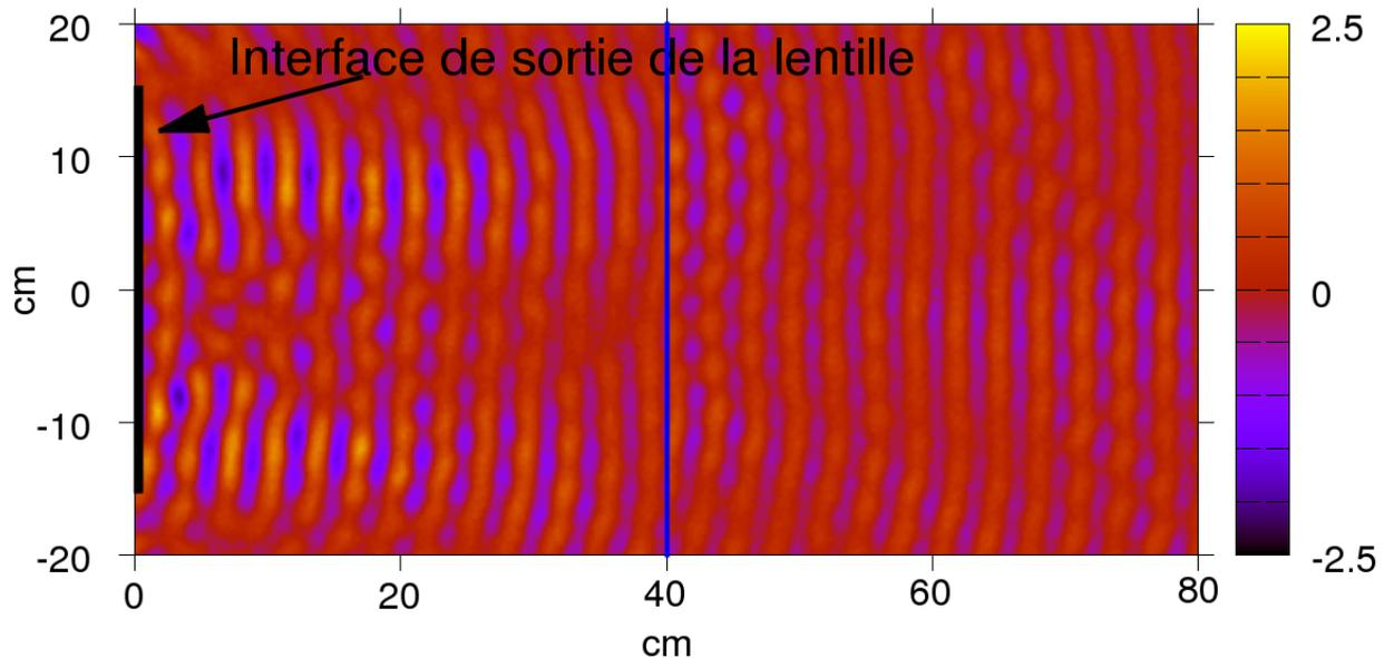
FIGURE 3.20 – [Expérimentation] Cartographie de la valeur instantanée du champ électrique  $E_z$  ( $\Re(S_{12})$ ) lorsqu’une onde cylindrique à  $\nu = 9,6$  GHz issue d’une antenne monopole au point focal traverse la lentille à gradient d’indice positif. Le relevé a été effectué en deux temps : premièrement, de 0 à 40 cm de l’interface de sortie de la lentille puis de 40 cm à 80 cm. Les fronts d’onde en sortie sont plans.
