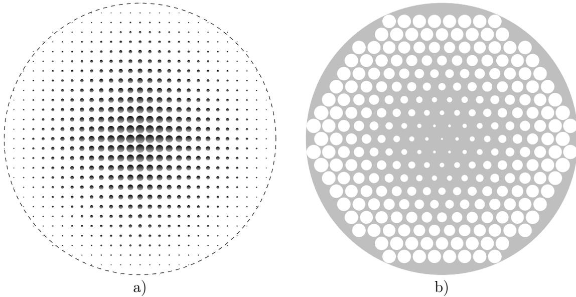
FIGURE 3.30 – Schémas des lentilles de Lüneburg simulées. Le gradient est 2D. a) Elle est constituée de tiges d'alumine. Le réseau est carré et la pas de la maille vaut  $a = 7$  mm. b) Elle est constituée de trous d'air dans du téflon. Le réseau est triangulaire et le pas de la maille vaut  $a = 10$  mm.
