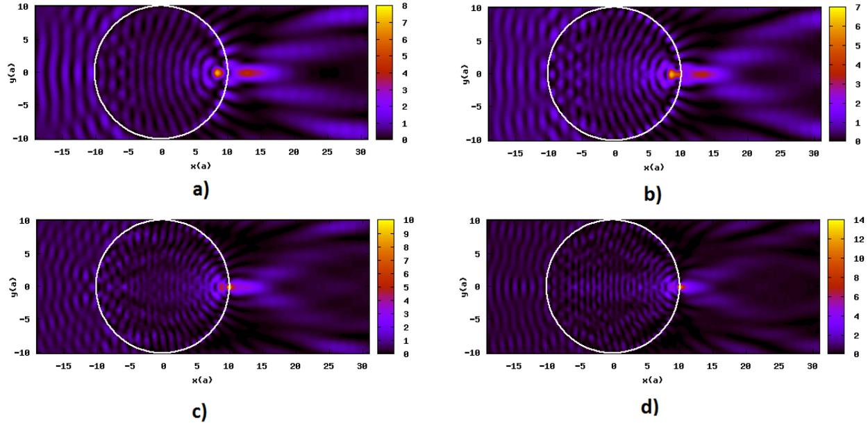
FIGURE 3.38 – [Simulation] Cartographie de la valeur moyenne du champ  $E_z^2$  sur une période ( $\overline{E_z^2}$ ) lorsqu'une onde plane sinusoïdale incidente à a)  $\nu = 8$  GHz; b)  $\nu = 9$  GHz; c)  $\nu = 11$  GHz et d)  $\nu = 12$  GHz traverse la lentille de Luneburg constituée de trous d'air dans du téflon. Cette onde incidente n'est plus focalisée à la périphérie de la lentille et la « distance focale » augmente au fur-et-à-mesure que la fréquence augmente.
