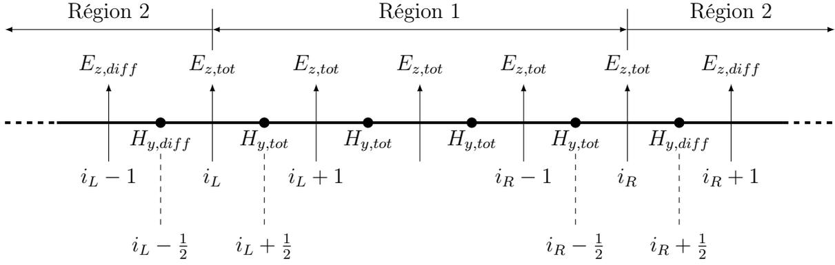
FIGURE 2.9 – Plan de coupe horizontal réalisé au niveau de l'interface entre les régions dites de *champ total* et de *champ diffusé*. Cette coupe montre quelles sont les composantes de champs présentes au niveau de cette interface et leurs positions dans la grille de simulation FDTD dans le cas d'une polarisation TM [112].
