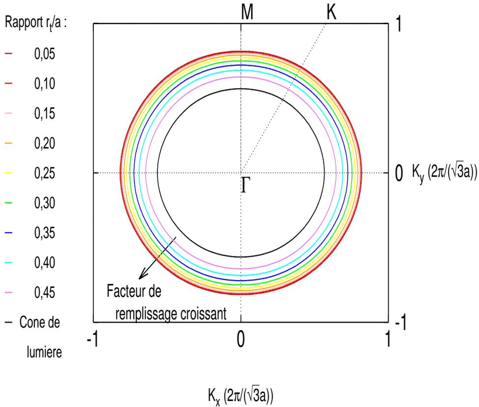
FIGURE 3.35 – Courbes iso-fréquences dans la première bande permise à  $\nu = 10$  GHz d’un cristal photonique diélectrique à maille triangulaire. Il est constitué de trous d’air dont on fait varier le rayon dans du téflon. Le pas  $a = 10$  mm et  $a/\lambda = 0,33$ . La polarisation est transverse magnétique (TM).
