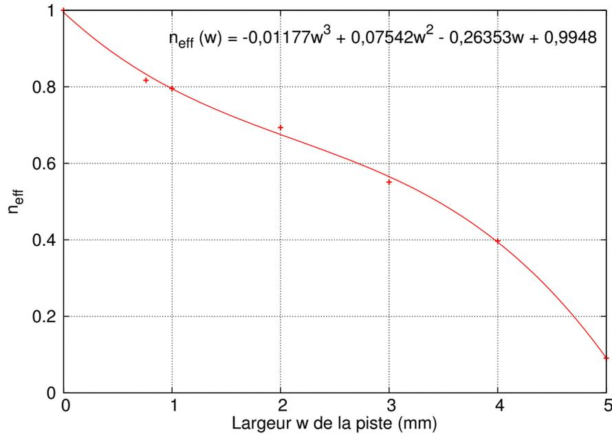
FIGURE 3.10 – Courbe d’étalonnage  $n_{\text{eff}}(w)$  en fonction de la largeur de piste de cuivre utilisée. Celle-ci est dans l’air. L’interpolation a été réalisée grâce à la méthode des moindres carrés à l’ordre 3.
