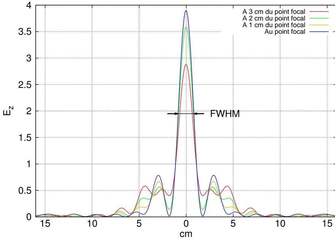
FIGURE 3.27 – [Simulation] Coupes effectuées au niveau du plan focal et autour lorsqu’une onde plane sinusoïdale traverse la lentille à gradient d’indice négatif à la fréquence de  $\nu = 9$  GHz. Nous obtenons, au mieux, une largeur à mi-hauteur de  $0,5 \cdot \lambda$ .
