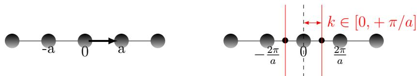
FIGURE 1.5 – Exemple de cristal photonique unidimensionnel (à gauche) et zone de Brillouin correspondante (à droite). L'intervalle  $[-\frac{\pi}{a}; +\frac{\pi}{a}]$  est la première zone de Brillouin et  $[0; +\frac{\pi}{a}]$  la zone de Brillouin irréductible.
