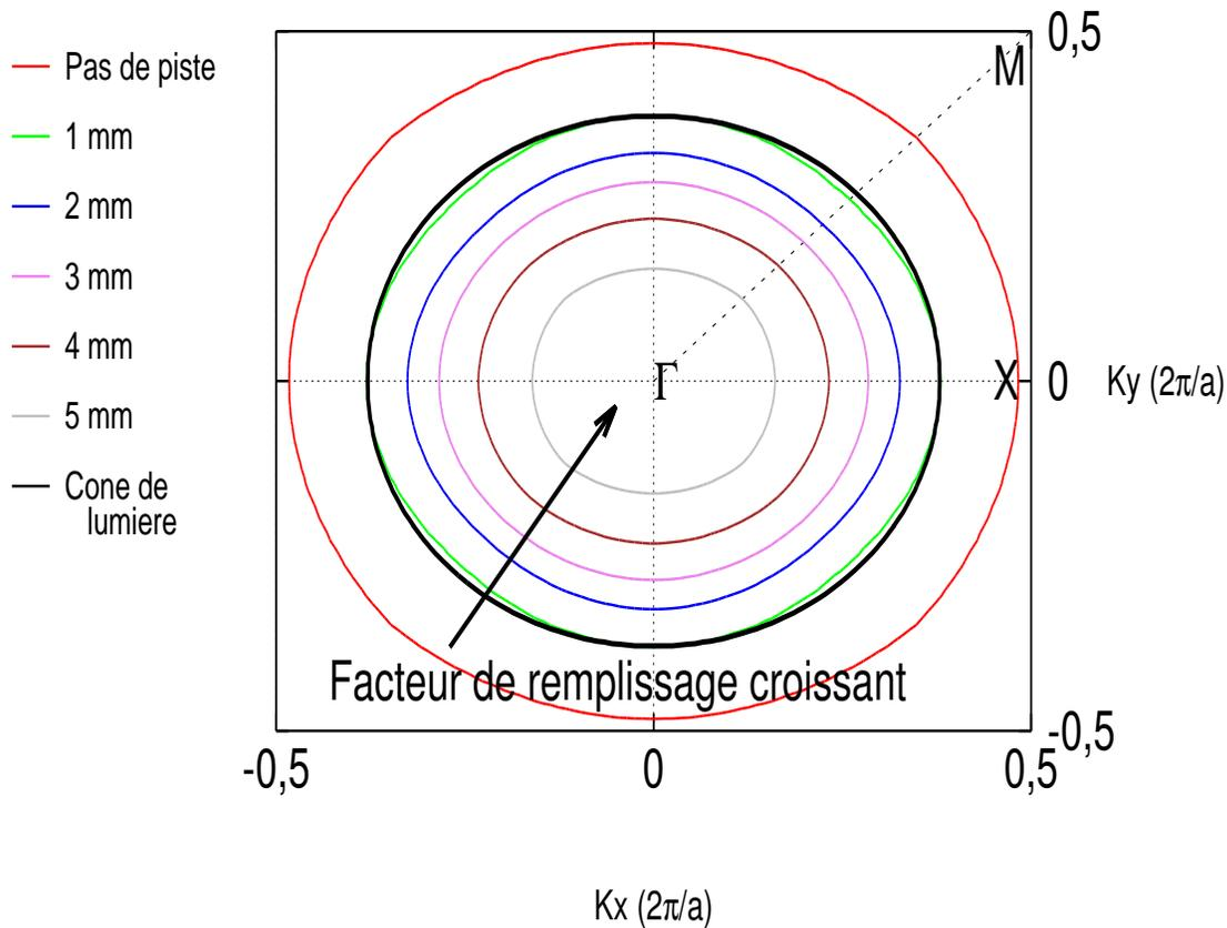
FIGURE 3.12 – Courbes iso-fréquences dans la première bande permise à  $\nu = 9,6$  GHz d'un cristal photonique à maille carrée de pas  $a = 12$  mm ( $a/\lambda = 0,384$ ) constitué de pistes de cuivre de  $35 \mu\text{m}$  d'épaisseur situées sur du FR4 et dont on a fait varier la largeur. La polarisation est transverse magnétique (TM).
