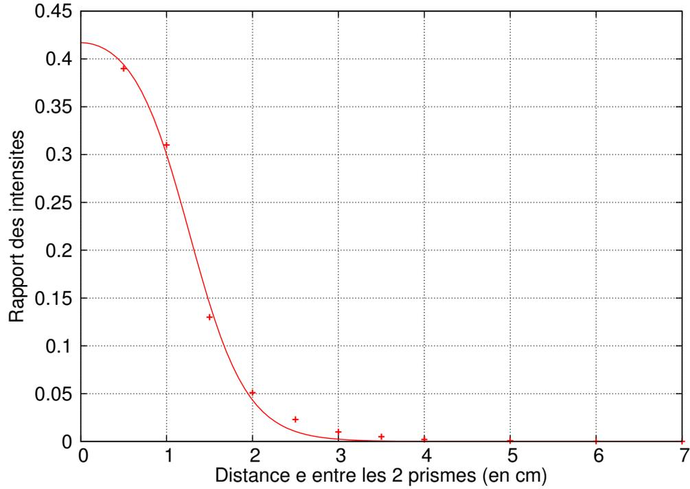
FIGURE 4.7 – Rapport des intensités entre la valeur maximale du champ  $\overline{\mathbf{E}_z^2}$  transmis et la valeur maximale du champ  $\overline{\mathbf{E}_z^2}$  incident en fonction de l'écart  $e$  entre les deux prismes à cristal photonique.
