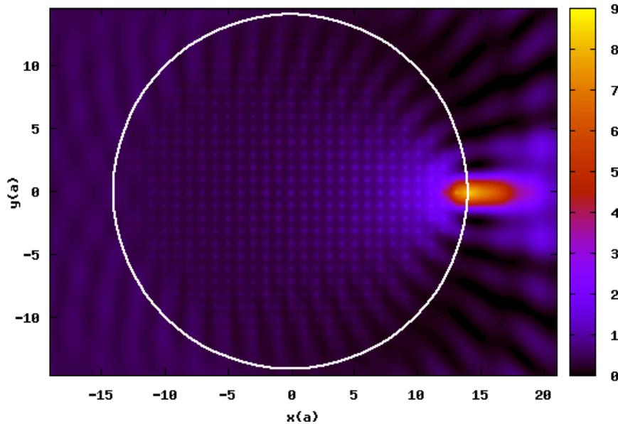
FIGURE 3.31 – [Simulation] Cartographie de la valeur moyenne du champ  $E_z^2$  sur une période ( $\overline{E_z^2}$ ) lorsqu'une onde plane sinusoïdale incidente à  $\nu = 9$  GHz traverse la lentille de Lüneburg constituée de tiges d'alumine. Cette onde incidente est focalisée à la périphérie de la lentille.
