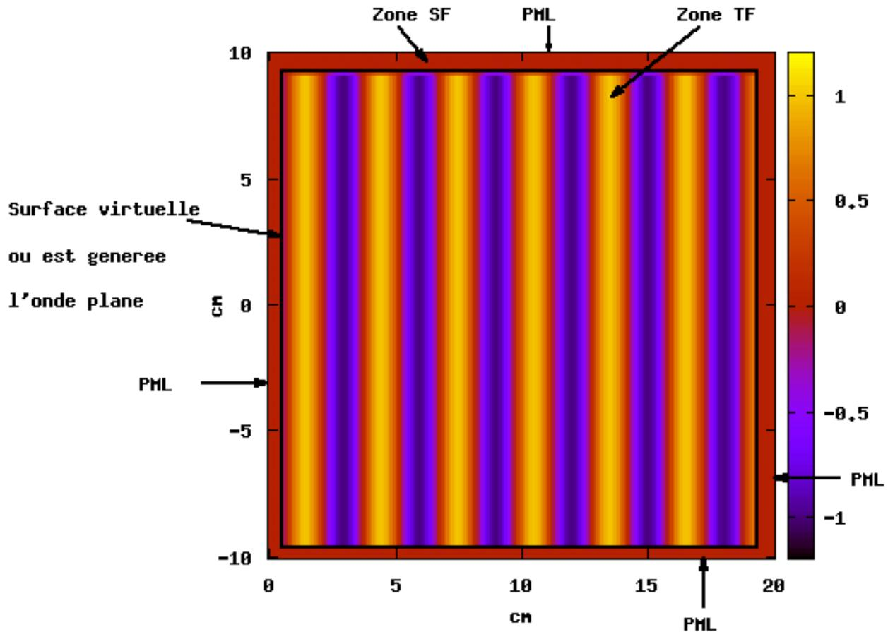
FIGURE 2.10 – Simulation de la propagation d’une onde plane sinusoïdale dans le vide à  $\nu = 10$  GHz. Les différentes régions présentées sur la figure 2.8 sont repérées. Lorsque l’onde plane générée se propage dans le vide, il n’y a aucun champ diffusé dans la zone SF.
