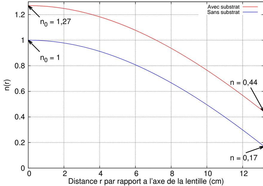
FIGURE 3.11 – Profil d'indice  $n(r)$  de la lentille à gradient d'indice positif constituée de cinq couches de pistes de cuivre dans l'air (en bleu) et sur circuit imprimé (en rouge). Les paramètres utilisés pour ce profil d'indice sont :  $n_0 = 1$  ;  $d = 6$  cm ;  $f = 15$  cm.  $n_0 = 1,27$  lorsqu'il est tenu compte du substrat.
