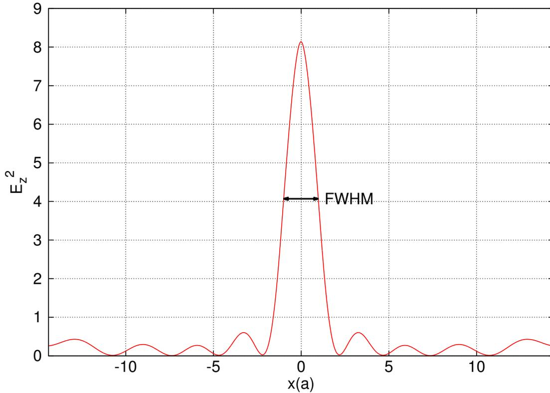
FIGURE 3.32 – [Simulation] Coupe effectuée au niveau du plan focal obtenu en simulation lorsqu’une onde plane sinusoïdale TM à  $\nu = 9$  GHz traverse la lentille de Lüneburg à cristal photonique en alumine. La courbe a l’allure d’un sinus cardinal. La largeur à mi-hauteur obtenue est  $FWHM \approx 0,42 \cdot \lambda$ .
