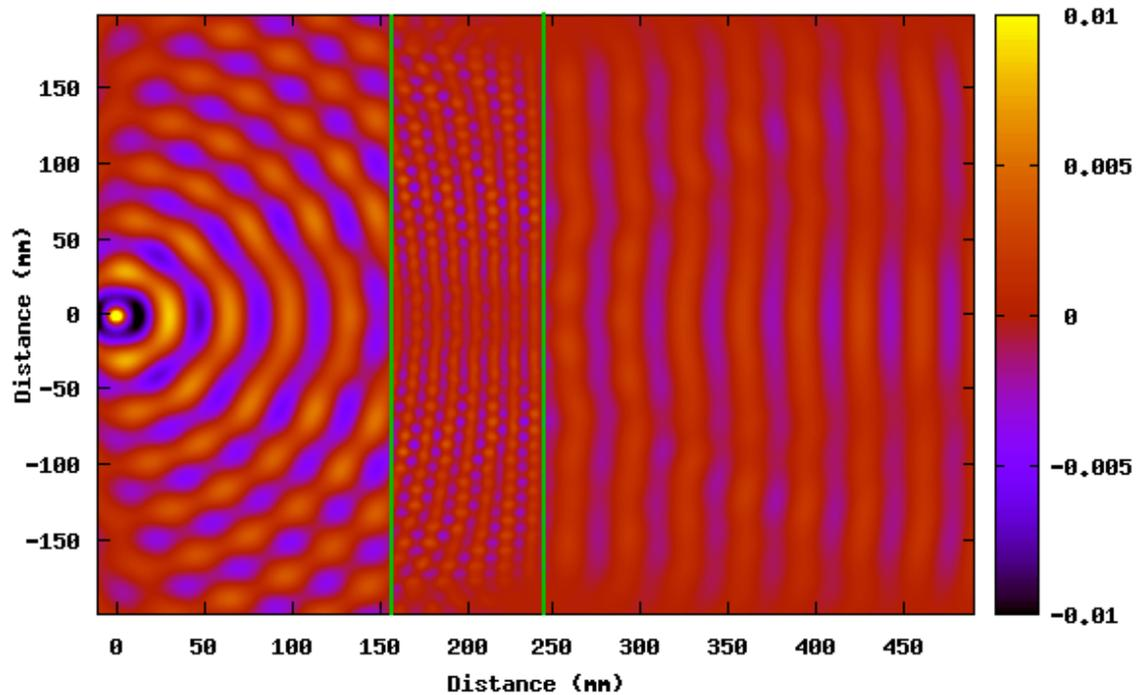
FIGURE 3.26 – [Simulation] Cartographie de la valeur instantanée du champ électrique  $E_z$  lorsqu’une onde cylindrique à  $\nu = 9$  GHz issue d’une source ponctuelle TM à la distance focale  $f = 16$  cm traverse la lentille à gradient d’indice négatif. La lentille est délimitée par les deux traits verts verticaux. Les fronts d’onde incidents sont circulaires ; ceux de l’onde transmise sont plans.
