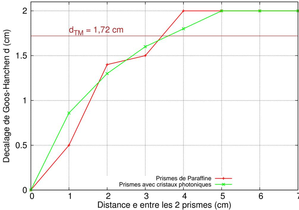
FIGURE 4.10 – Décalages de Goos-Hänchen  $d$  en fonction de l'écart  $e$  entre les deux prismes de paraffine (courbe rouge) et constitués par des cristaux photoniques en alumine (courbe verte). On note que les résultats obtenus sont à peu près concordants sauf pour la valeur asymptotique qui, d'après l'équation 4.17 vaut  $d_{TM} = 1,72$  cm.
