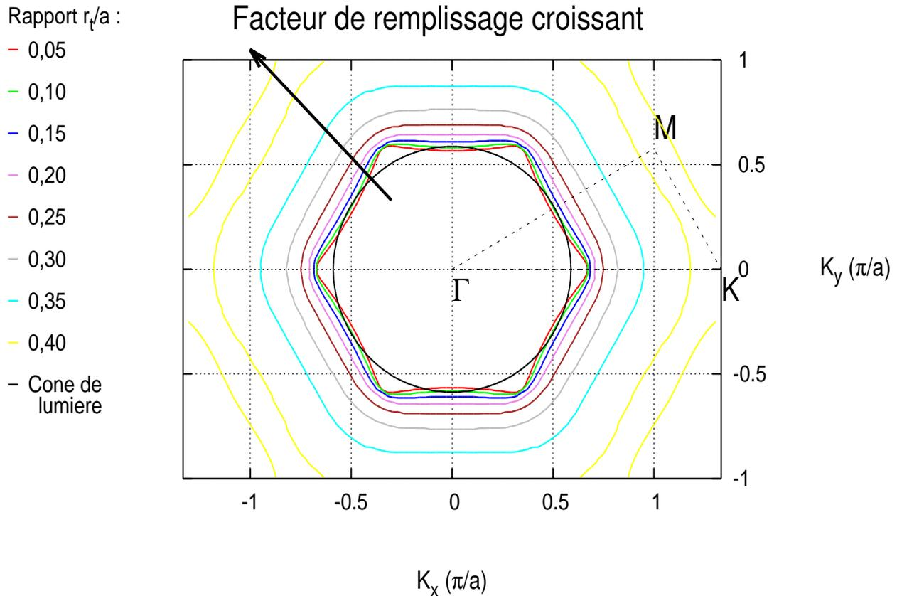
FIGURE 3.23 – Courbes iso-fréquences dans la deuxième bande permise à  $\nu = 9$  GHz d'un cristal photonique diélectrique à maille triangulaire de pas  $a = 10$  mm ( $a/\lambda = 0,3$ ). Il est constitué de trous d'air dans de l'alumine. La polarisation est transverse magnétique (TM).
