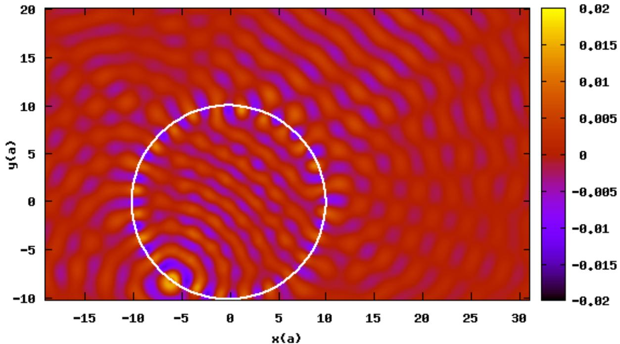
FIGURE 3.37 – [Simulation] Cartographie de la valeur instantanée du champ électrique  $E_z$  lorsqu'une onde cylindrique issue d'une source ponctuelle TM à  $\nu = 10$  GHz située sur la périphérie traverse la lentille de Luneburg constituée de trous d'air dans du téflon. Les fronts d'onde en sortie sont plans.
