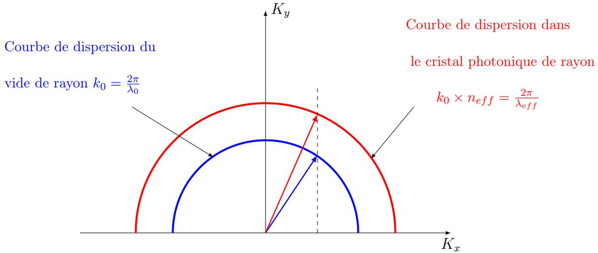
FIGURE 3.6 – Relation de dispersion dans le plan  $(k_x; k_y)$ , pour une fréquence donnée, d'un cristal photonique LHI. La courbe de dispersion du vide est représenté en bleu et la courbe de dispersion du cristal photonique en rouge. La composante  $k_x$  du vecteur d'onde est conservée. Dans ce cas,  $n_{eff} > 1$ .
