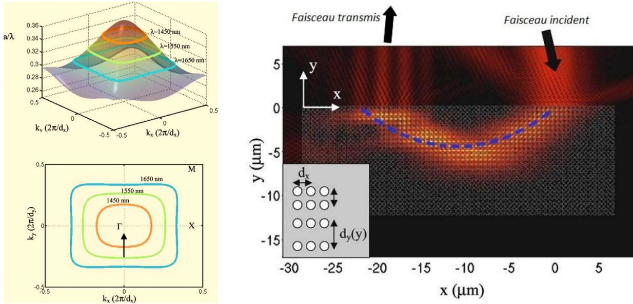
FIGURE 3.2 – Mise en évidence de la possibilité offerte par les cristaux photoniques à gradient : en jouant sur le facteur d'aspect  $\Delta x/\Delta y$  qui est très légèrement modifié, il est possible de d'imiter l'effet de mirage atmosphérique (à droite). Cela est rendu possible par le fait que la direction du vecteur d'onde de l'onde électromagnétique qui traverse la structure est fixée par la normale aux courbes iso-fréquences comme le montre la figure de gauche [126].
