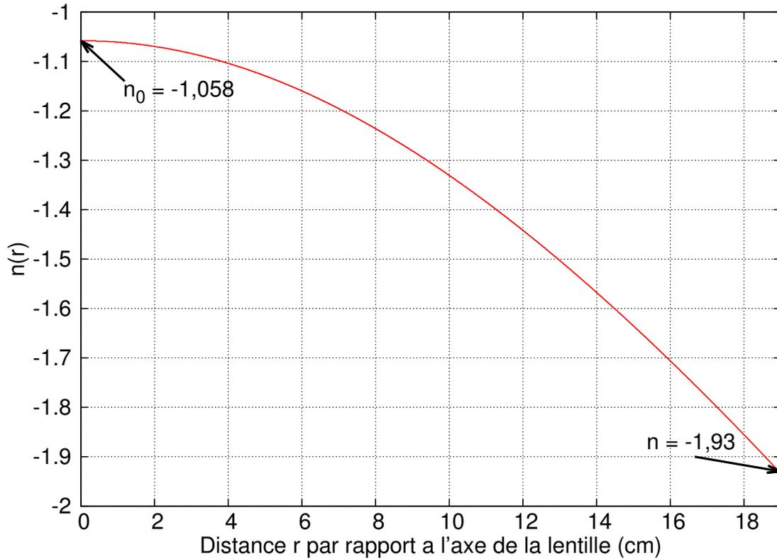
FIGURE 3.24 – Profil d’indice de la lentille à gradient d’indice négatif constituée de trous d’air dans de l’alumine. Les paramètres utilisés pour ce profil d’indice sont :  $n_0 = -1,058$  ;  $d = 8,66$  cm ;  $f = 20$  cm (cf. formule 3.3)
