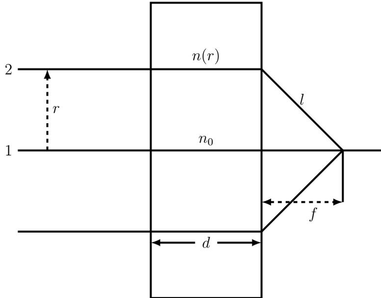
FIGURE 3.4 – Lentille plate à gradient d’indice telle que décrite par O. Pinchuk et George C. Schatz.  $n_0$  est l’indice de réfraction le long de l’axe de la lentille,  $n(r)$  est l’indice de réfraction à une distance  $r$  de l’axe de la lentille,  $d$  est son épaisseur et  $f$  sa distance focale [132].
