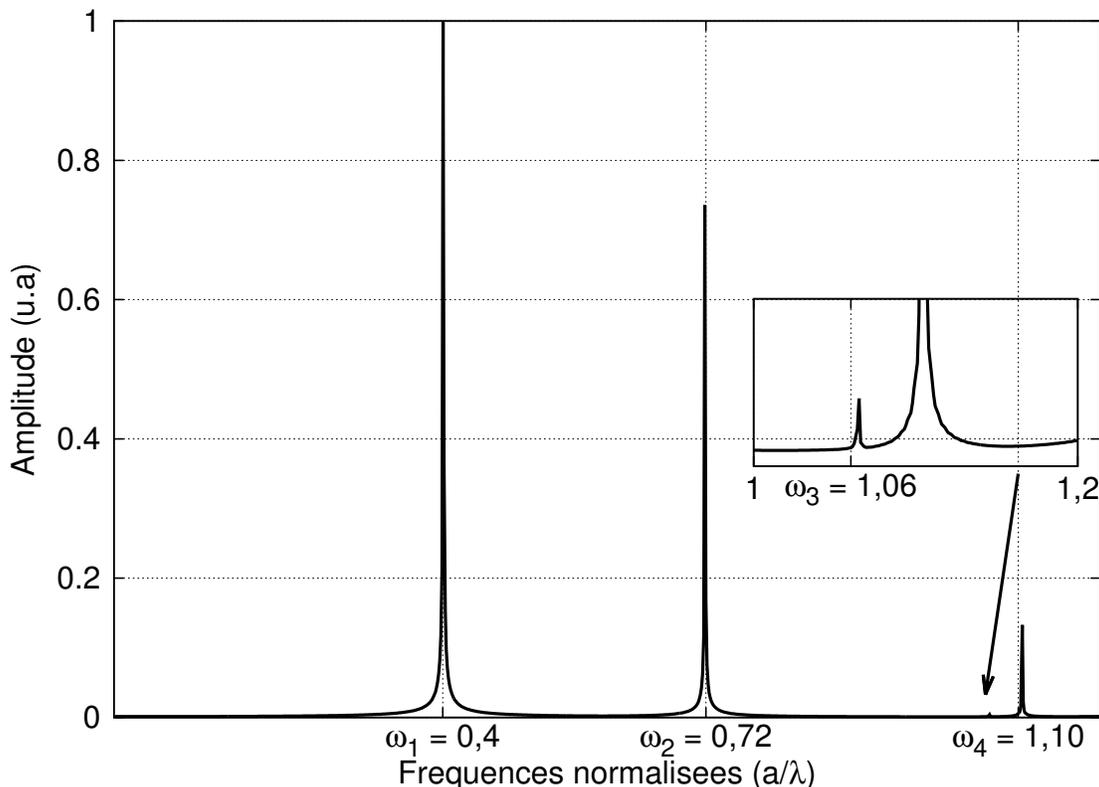
FIGURE 2.4 – Exemple de spectre montrant les modes de Bloch obtenus pour un couple  $(k_x; k_y)$  donné. Le cristal photonique pris pour cet exemple est constitué de tiges de cuivre dans l'air. Ce spectre montre les quatre premières résonances aux fréquences  $\omega_1 = 0,4$ ,  $\omega_2 = 0,72$ ,  $\omega_3 = 1,06$  et  $\omega_4 = 1,10$ .
