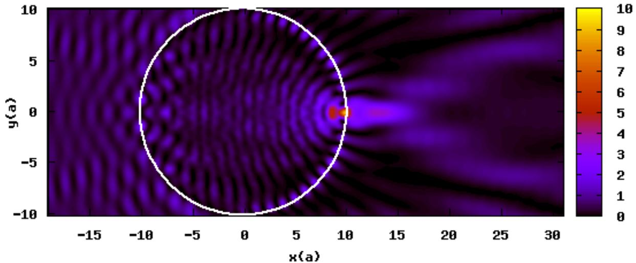
FIGURE 3.36 – [Simulation] Cartographie de la valeur moyenne du champ  $E_z^2$  sur une période ( $\overline{E_z^2}$ ) lorsqu'une onde plane sinusoïdale incidente à  $\nu = 10$  GHz traverse la lentille de Luneburg constituée de trous d'air dans du téflon. Cette onde incidente est focalisée à la périphérie de la lentille.
