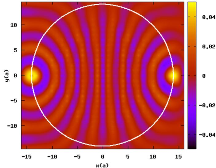
FIGURE 3.39 – [Simulation] FDTD de la lentille de Maxwell Fisheye conçue avec des tiges d'alumine dans l'air. L'onde cylindrique issue d'une source ponctuelle TM à  $\nu = 9$  GHz située sur la périphérie est focalisée au point symétrique par rapport au centre de la lentille.
