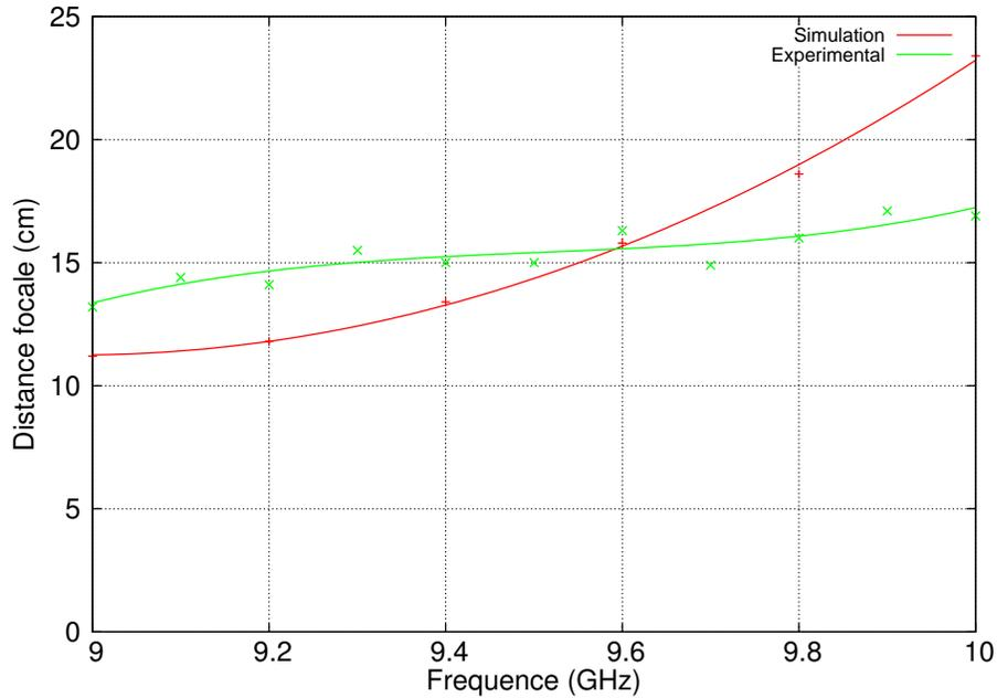
FIGURE 3.16 – Variation de la distance focale  $f$  en fonction de la fréquence de l'onde plane sinusoïdale incidente sur la lentille à gradient d'indice positif.
