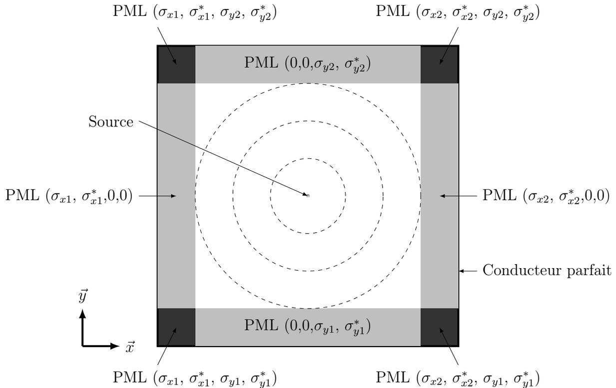
FIGURE 2.7 – Description de la grille FDTD incluant des zones PML telle qu'elle a été proposée par Berenger.  $\sigma_{x1}$ ,  $\sigma_{x2}$ ,  $\sigma_{y1}$  et  $\sigma_{y2}$  symbolisent des conductivités et  $\sigma_{x1}^*$ ,  $\sigma_{x2}^*$ ,  $\sigma_{y1}^*$  et  $\sigma_{y2}^*$  symbolisent des pertes magnétiques [119].
