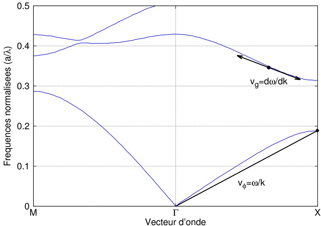
FIGURE 1.7 – Structure de bandes d'un cristal photonique 2D à maille carrée où sont représentées graphiquement les vitesses de phase  $v_\phi$  et de groupe  $v_g$  pour une onde plane se propageant dans la direction  $\Gamma - X$ . En un point de la courbe de dispersion, la vitesse de phase s'obtient à partir du rapport  $\omega/k$  et la vitesse de groupe à partir de la tangente à la courbe.
