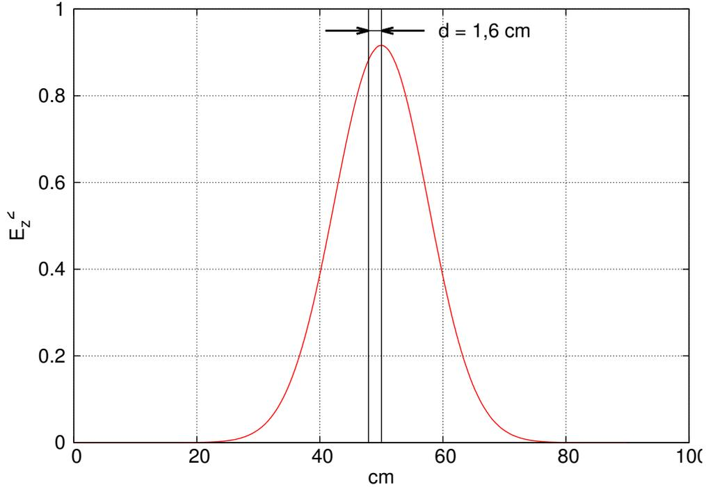
FIGURE 4.9 – Champ  $\overline{\mathbf{E}}_z^2$  issu de la figure 4.4 suivant un plan de coupe horizontal en sortie du premier prisme constitué par des cristaux photoniques lorsque les deux prismes sont séparés de  $e = 3$  cm. Le décalage de Goos-Hänchen (distance entre la ligne verticale noire et le maximum de  $\overline{\mathbf{E}}_z^2$ ) est estimé à  $d \approx 1,6$  cm.
