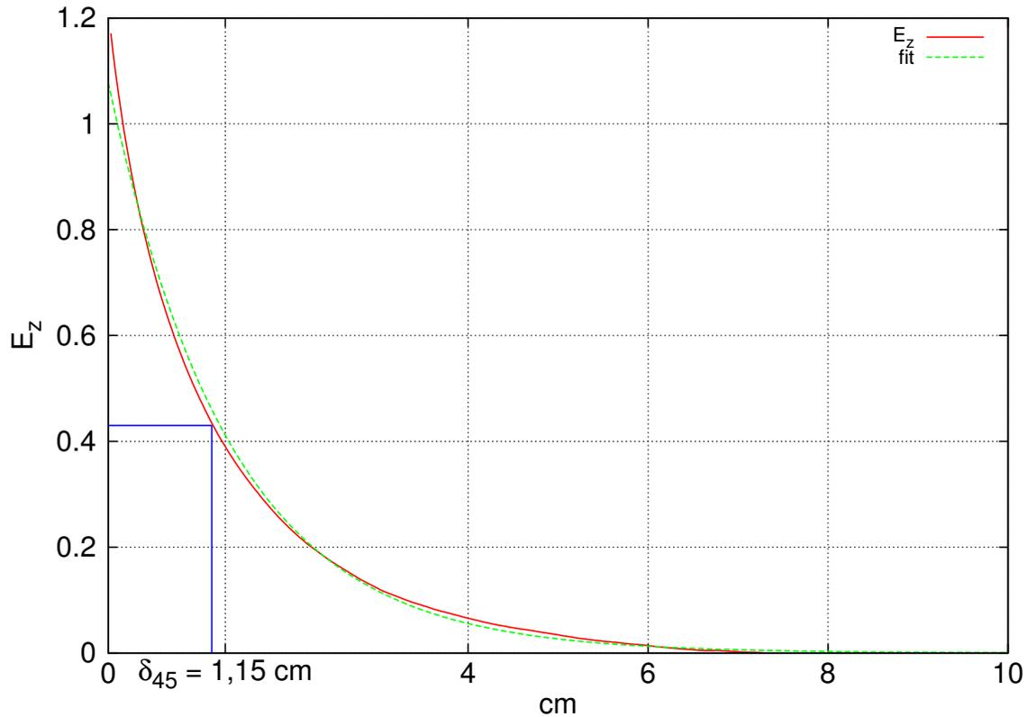
FIGURE 4.6 – Profondeur de pénétration de l’onde évanescente en sortie d’un prisme à cristaux photoniques d’alumine. Elle est obtenue en traçant une coupe du champ  $E_z$  suivant la normale à la face de sortie de ce prisme (courbe rouge). La courbe verte est la courbe théorique obtenue en réalisant un *fit* [188].
