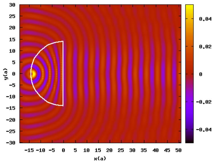
FIGURE 3.40 – [Simulation] FDTD de la lentille Half Maxwell Fisheye conçue avec des tiges d'alumine dans l'air. La fréquence de fonctionnement optimal de cette lentille est de  $\nu = 9$  GHz. Cette cartographie du champ électrique  $E_z$  instantané montre que l'onde cylindrique issue de la source ponctuelle TM située à la périphérie de la lentille ressort en onde plane sinusoïdale, ce qui est le résultat attendu d'une telle lentille.
