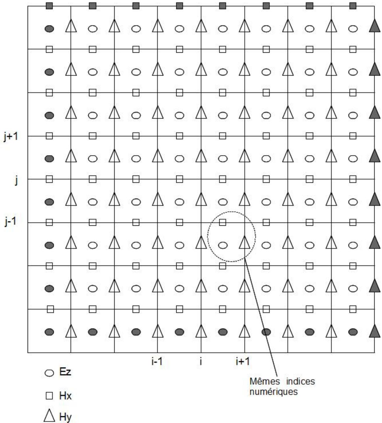
FIGURE 2.11 – Grille FDTD 2D en polarisation TM. Les différents champs  $H_x, H_y$  et  $E_z$  et leurs indices correspondants sont représentés. Les champs en bord de domaine et repérés en gris, ne pouvant être calculés à partir de l’algorithme de Yee, sont obtenus en imposant, par exemple, des conditions périodiques aux limites.
