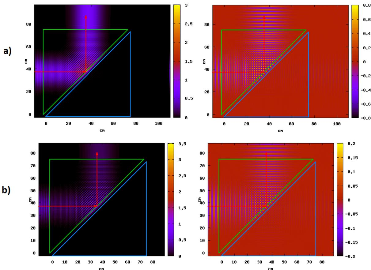
FIGURE 4.4 – Cartographie de la valeur moyenne du carré du champ électrique ( $\overline{E_z^2}$ ) à gauche et valeur instantanée de  $E_z$  (à droite) d'une onde plane sinusoïdale incidente TM à  $\nu = 10$  GHz sur un ensemble de deux prismes constitués par a) de la paraffine et b) des cristaux photoniques d'alumine. Ils sont séparés de  $e = 3$  cm. Les flèches rouges indiquent la trajectoire déduite de l'optique géométrique. La transmission à travers le deuxième prisme est très faible.
