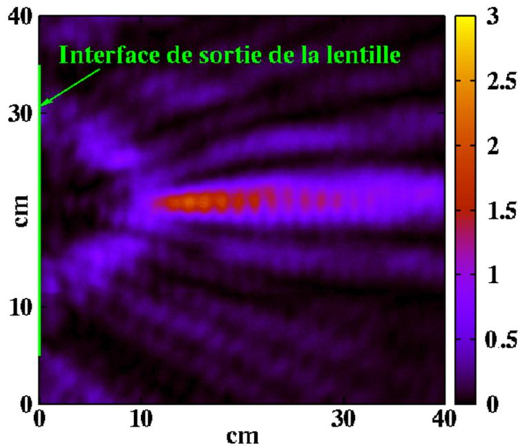
FIGURE 3.19 – [Expérimentation] Cartographie de la valeur moyenne de  $S_{21}^2$  sur une période lorsque l’antenne cornet est polarisée verticalement (champ électrique parallèle aux pistes). Elle émet une onde plane sinusoïdale à  $\nu = 9,6$  GHz qui traverse la lentille à gradient d’indice positif qui est délimitée par le trait vert vertical. La distance focale obtenue est d’environ 15 cm.
