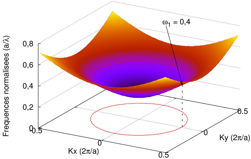
FIGURE 2.6 – Exemple de surface iso-fréquence obtenu lorsque l'ensemble des modes de Bloch ont été reportés pour chaque couple  $(k_x; k_y)$  de la zone de Brillouin non réduite. Le cristal photonique pris pour cet exemple est constitué de tiges de cuivre dans l'air. Cette surface iso-fréquence montre la première résonance à la fréquence  $\omega_1 = 0,4$  ainsi que sa projection dans le plan  $(k_x; k_y)$ . Dans ce cas particulier, il s'agit d'un cercle.
