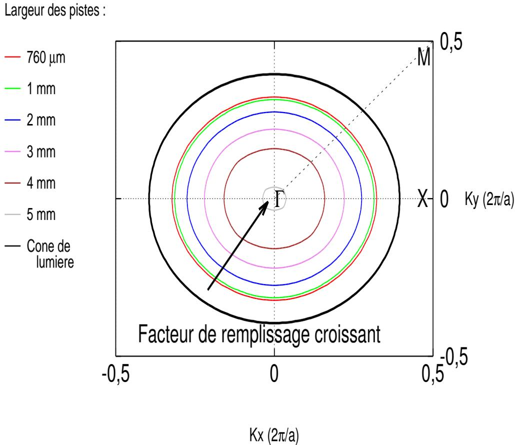
FIGURE 3.9 – Courbes iso-fréquences dans la première bande permise à  $\nu = 10$  GHz d'un cristal photonique métallique à maille carrée. Le pas  $a = 12$  mm ( $a/\lambda = 0,4$ ). Il est constitué de pistes de cuivre de  $35 \mu\text{m}$  d'épaisseur dont on a fait varier la largeur. Celles-ci sont dans l'air. La polarisation est transverse magnétique (TM). Le rayon des courbes iso-fréquences du cristal photonique est inférieur à celui du cône de lumière, donc  $n_{eff} \leq 1$ .
