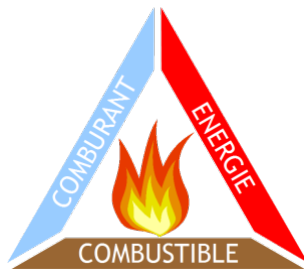
FIGURE 1 – Triangle du feu (figure extraite de www.chimie.ch ).
