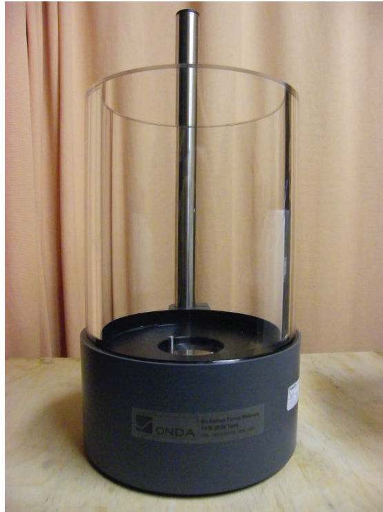
FIGURE 2.4: Photographie d'une balance acoustique. Un transducteur est placé dans le tube et émet des ultrasons sur l'absorbant placé en bas. La force de radiation acoustique est calculée grâce au changement de poids apparent de l'absorbant (RFB-2000 Radiation Force Balance, Onda Corporation, Sunnyvale, CA, USA)
